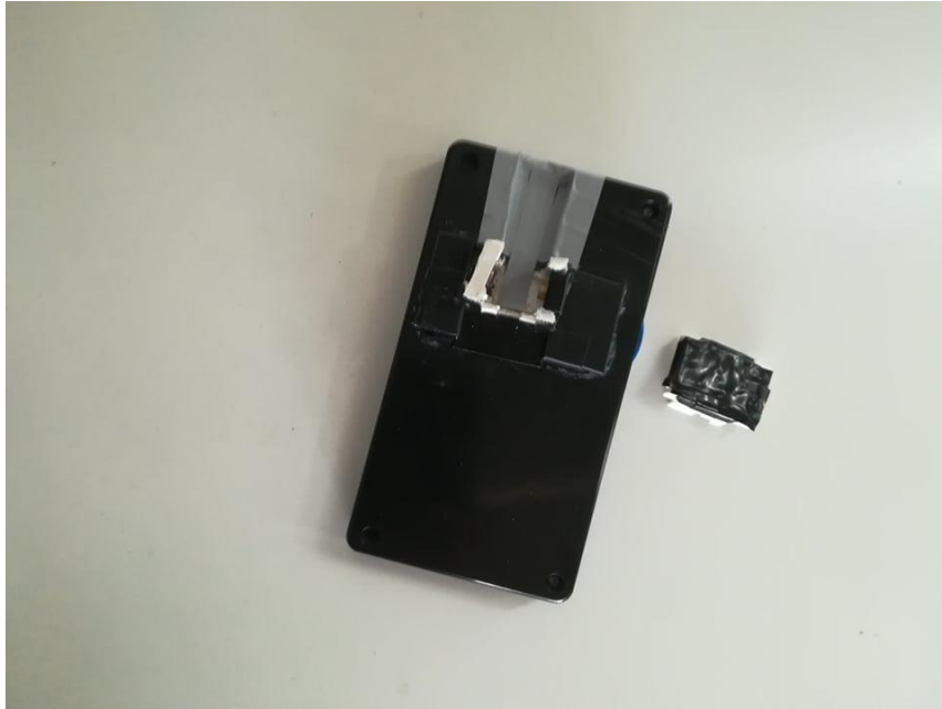
Σχήμα 23 : Το άνω μέρος με τον αισθητήρα φωτός laser
