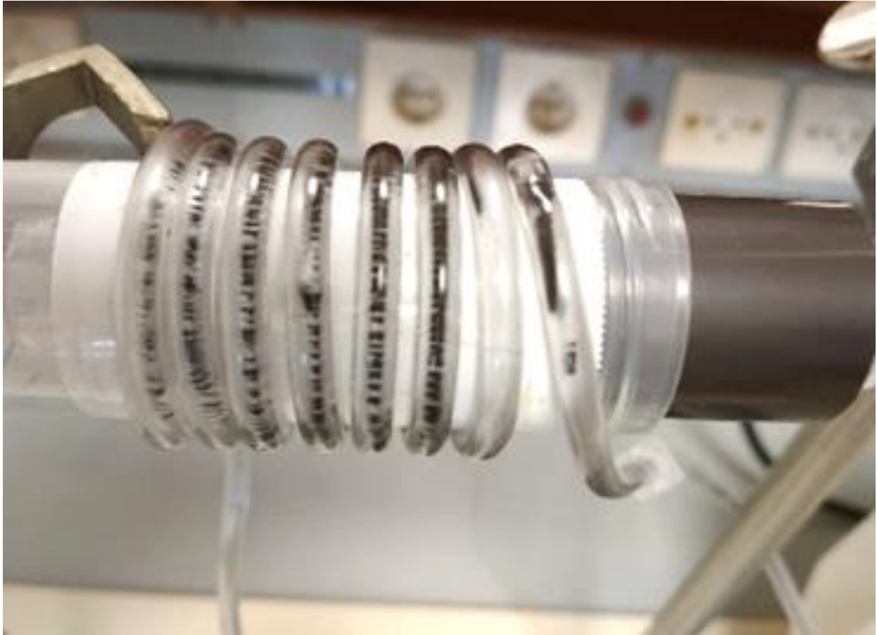
Σχήμα 31: Σταδιακή συσσώρευση μαγνητικών σωματιδίων
