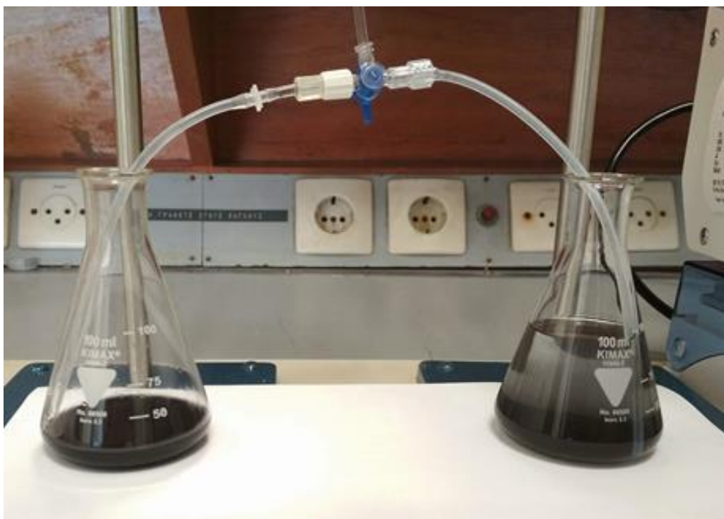
Σχήμα 37: Συλλογή μαγνητικών σωματιδίων σε ξεχωριστές φιάλες
