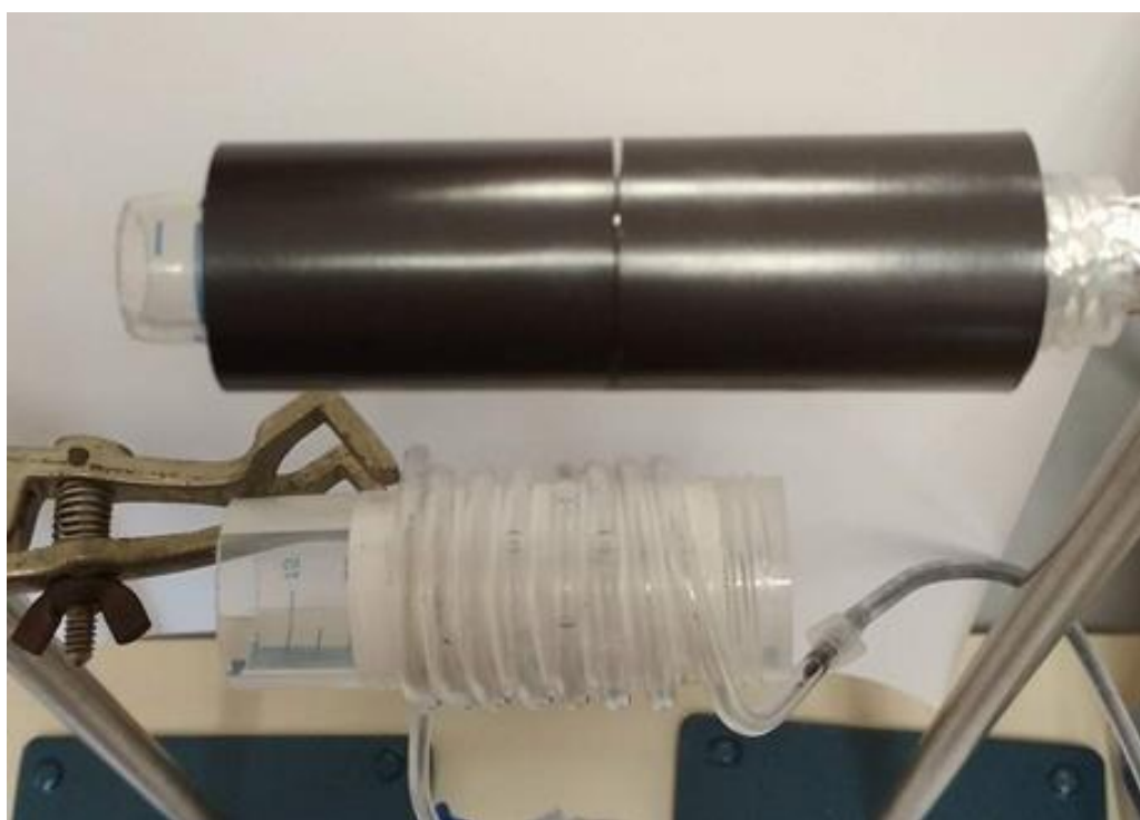
Σχήμα 38: Σπειροειδής σωλήνας τελείως καθαρός μετά από συλλογή μαγνητικών σωματιδίων
