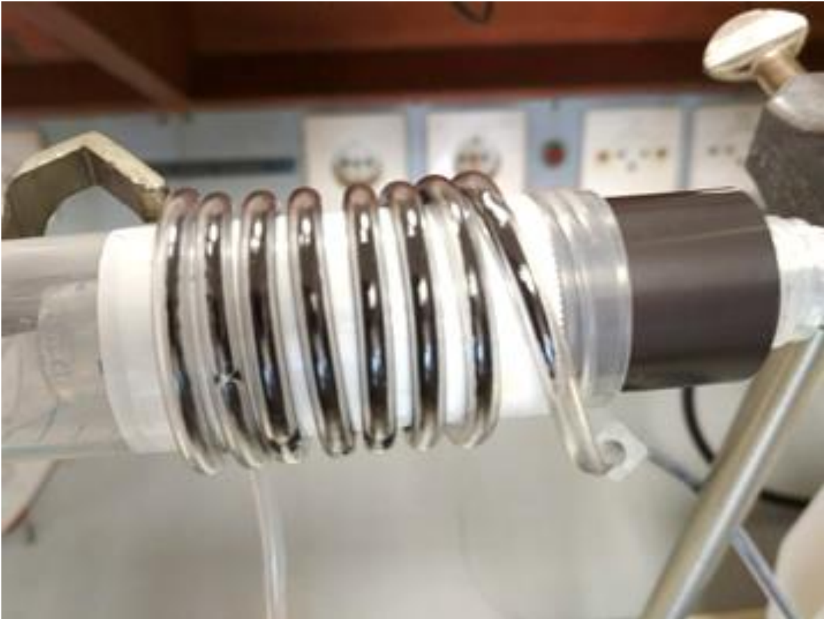
Σχήμα 32: Τελική συσσώρευση μαγνητικών σωματιδίων
