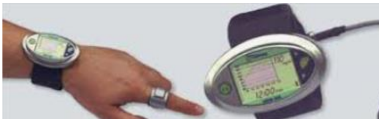
Εικόνα 8: Μη επεμβατική διάταξη. Η πίεση που ασκείται από το περιβραχιόνιο παρεμποδίζει προσωρινά τη ροή αίματος στο δάκτυλο, δημιουργώντας νέα δυναμική που παράγει ισχυρό οπτικό σήμα, αποδίδοντας καλή αναλογία σήματος-θορύβου.
