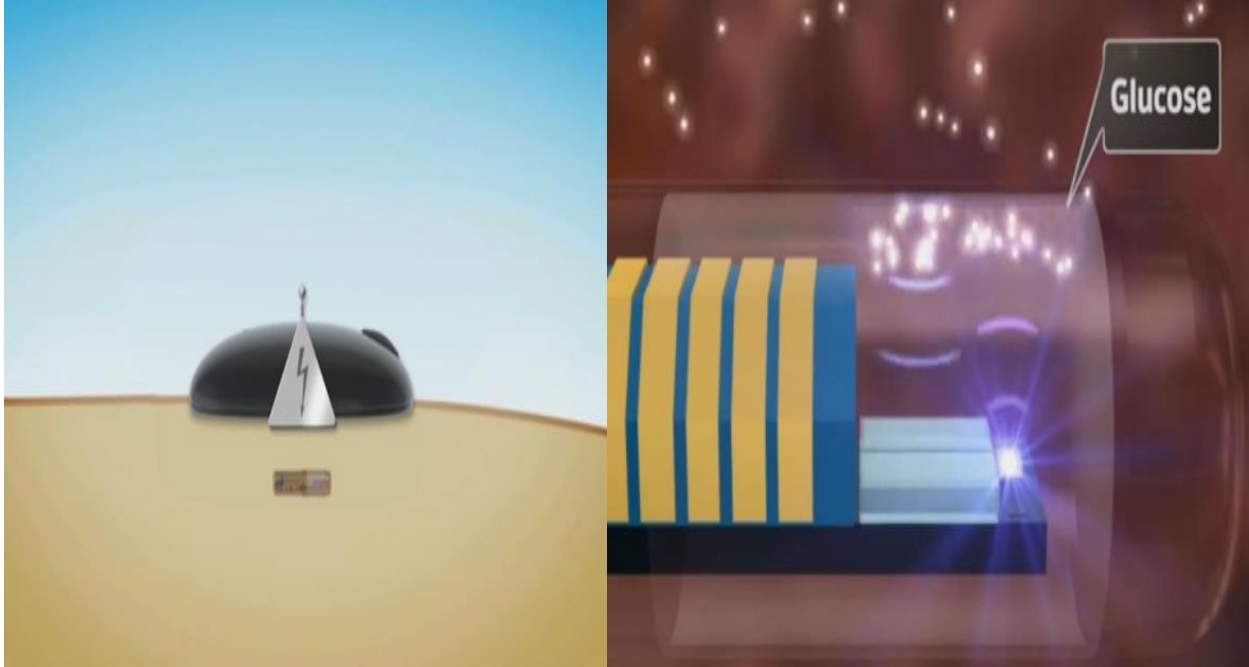
Εικόνα 7: Εμφυτεύσιμος υποδόριος αισθητήρας που χρησιμοποιεί ανίχνευση φθορισμού.
