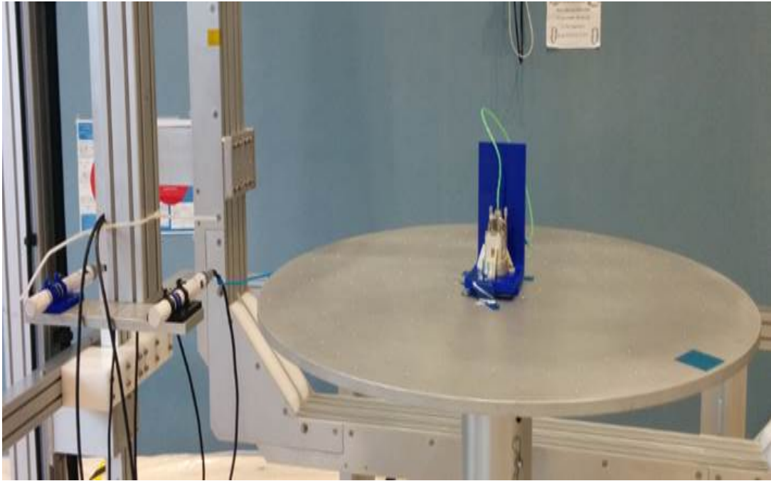
Εικόνα 43: Διάταξη για την πραγματοποίηση μετρήσεων AC μαγνητικού πεδίου του Διακόπτη Ραδιοσυχνοτήτων με Fluxgate Magnetometers (εργαστήριο Thales Alenia).
