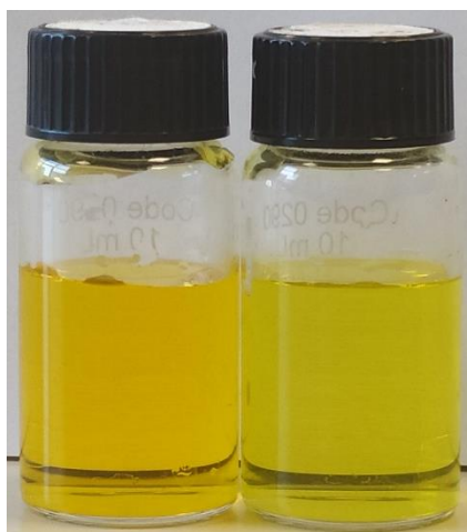
Εικόνα 10.1: Ένυδρο διάλυμα K_2Cr_2O_7 : αριστερά: πριν την επεξεργασία με ζεόλιθο, δεξιά: μετά την 3 η ώρα επεξεργασίας με LTX 2g/l
