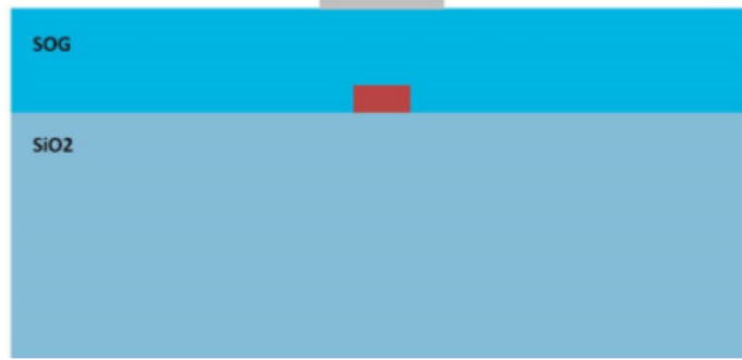
Εικόνα 3.4: Η πλάγια όψη (cross-section) του κυματοδηγού πυριτίου strip-τύπου
