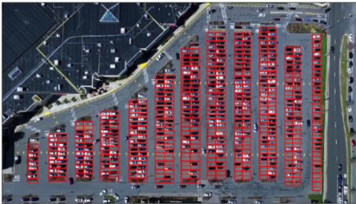
Σχήμα 7.2.1.1.4: Το τελικό αποτέλεσμα της ανίχνευσης των θέσεων στάθμευσης
