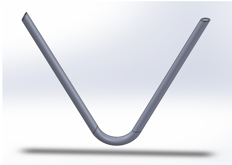
Εικόνα 27: Καινοτόμα γεωμετρία πηνίου, με γωνία προσαρμόσιμη στις εκάστοτε ανάγκες.
