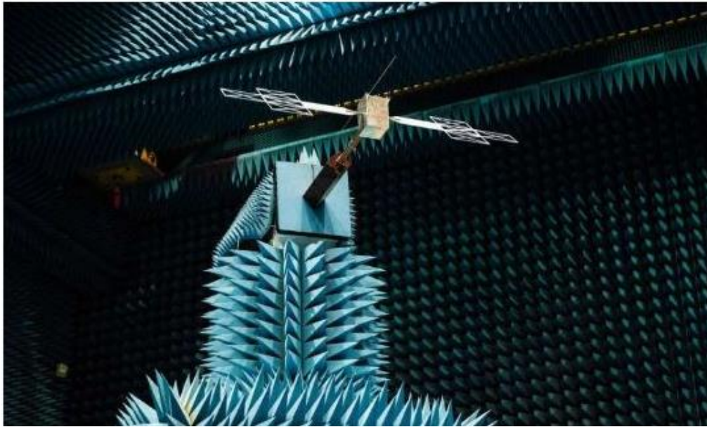
Εικόνα 4-2: Μοντέλο διαστημικού σκάφους Juice κατά τη διάρκεια δοκιμών EMC
