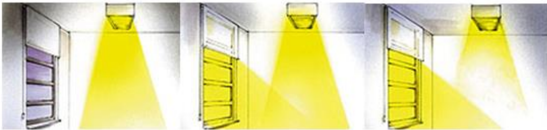
Εικόνα 5.15: Απεικόνιση λειτουργίας συστήματος σύζευξης φυσικού-τεχνητού φωτισμού [πηγή: http://www.cres.gr/energy_saving/Ktiria/texnitos_fotismos_systymata_elegxou.htm ]
