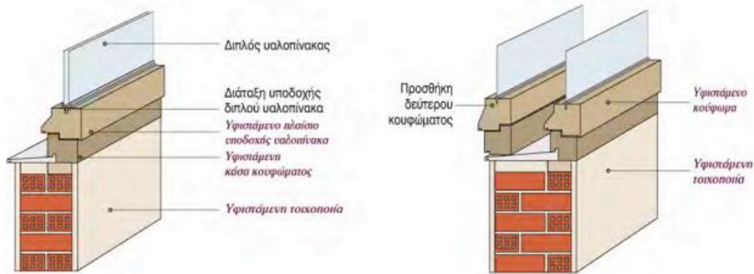
Εικόνα 4.1: Αντικατάσταση μονού με διπλό υαλοπίνακα (αριστερό σχήμα) και προσθήκη δεύτερου επιπλέον κουφώματος (δεξιά σχήμα)
