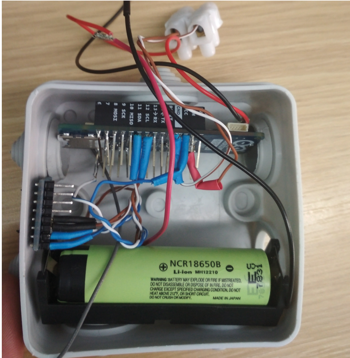
εικόνα 3.15: Ο συνολικός αισθητήρας MKR1500
