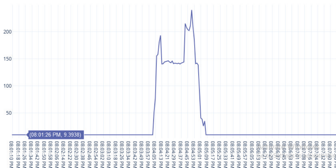
εικόνα 4.13: Κατανάλωση(mA) MKR1500 σε λειτουργία deepsleep
