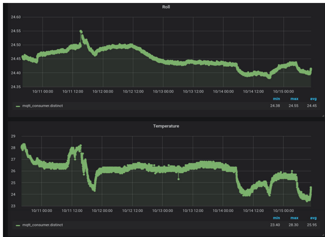
εικόνα 4.9: Επίδραση της θερμοκρασίας για το MKR1500
