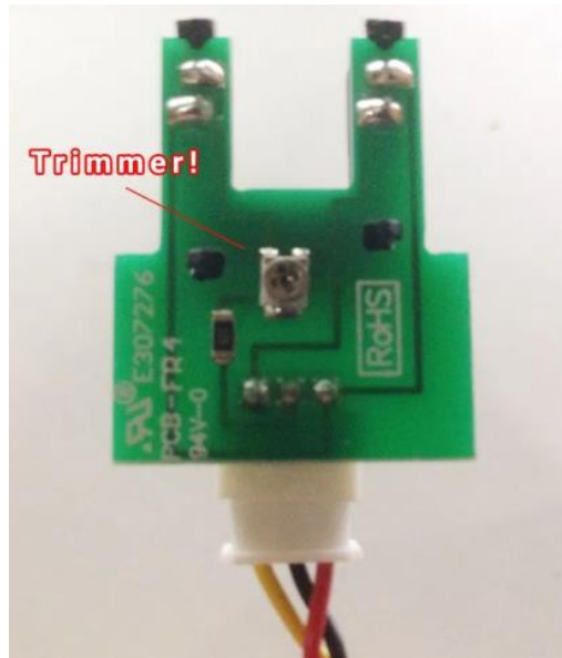
Σχήμα 39: Η τοποθεσία του ποτενσιόμετρου στον αισθητήρα
