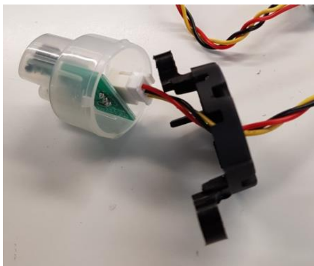
Σχήμα 38: Ο αισθητήρας χωρίς το πάνω καπάκι
