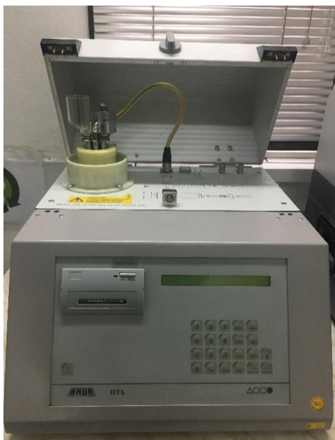
Σχήμα 4.10: Συσκευή μέτρησης εφδ, σχετικής διηλεκτρικής σταθεράς \epsilon_r και της ειδικής αντίστασης \rho DTL (Πηγή: Αρχείο ΣΕΜ-Α)
