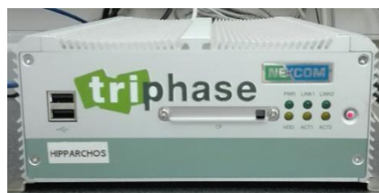
Εικόνα 2.29 Μονάδα ελέγχου (Target PC) των μετατροπέων ισχύος
