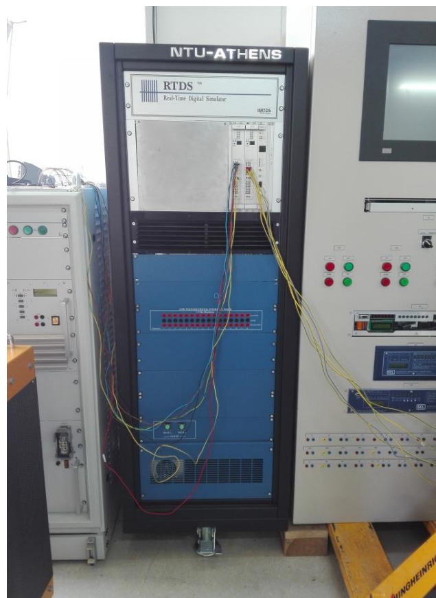
Εικόνα 2.26 Ο ψηφιακός προσομοιωτής πραγματικού χρόνου του εργαστηρίου ΣΗΕ
