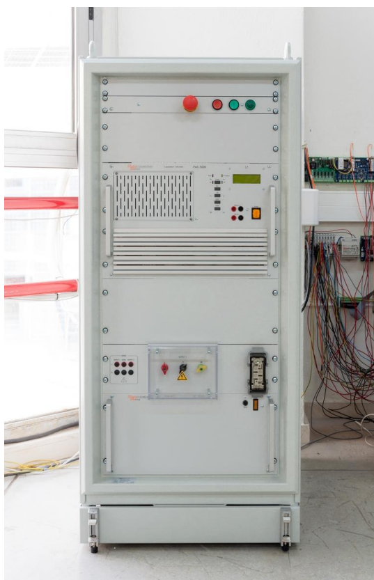
Εικόνα 2.27 Ο γραμμικός ενισχυτής Spitzenberger & Spies PAS 5000
