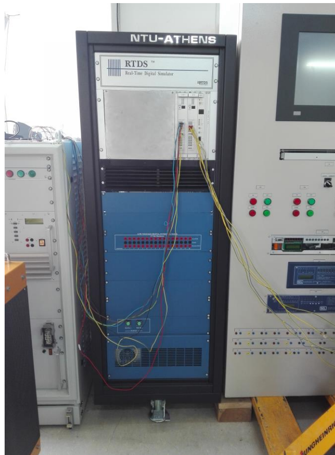
Εικόνα 3.20 Ο ψηφιακός προσομοιωτής πραγματικού χρόνου RTDS
