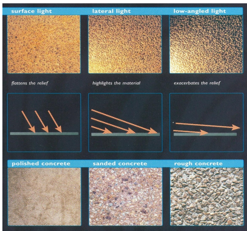
Εικόνα 3-1 Ανάδειξη της υφής των επιφανειών με επιλογή κατάλληλης δέσμης [18]
