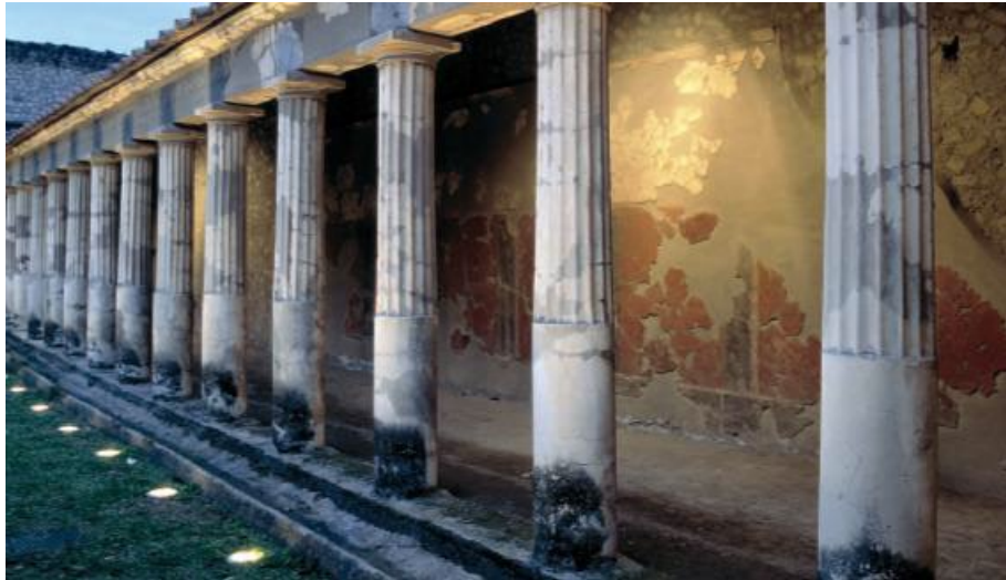
Εικόνα 3-13 Φωτισμός μνημείου ορατού από μία κατεύθυνση με επιπρόσθετο φωτισμό στο δομικό στοιχείο στο υπόβαθρο, Naples – Italy: Villa Oplontis ( Πηγή: External lighting systems, iGuzzini, 2011-2012).
