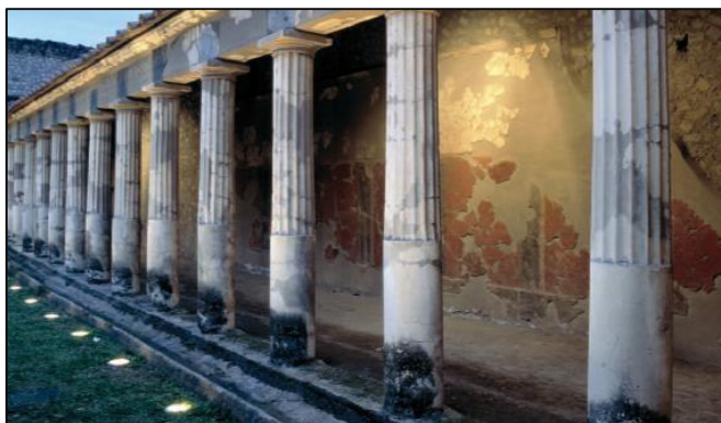
Εικόνα 27: Φωτισμός μνημείου ορατού από μία κατεύθυνση με επιπρόσθετο φωτισμό στο δομικό στοιχείο στο υπόβαθρο, Naples – Italy: Villa Oplontis (Πηγή: External lighting systems, iGuzzini , https://www.iguzzini.com/projects/project-gallery/ )
