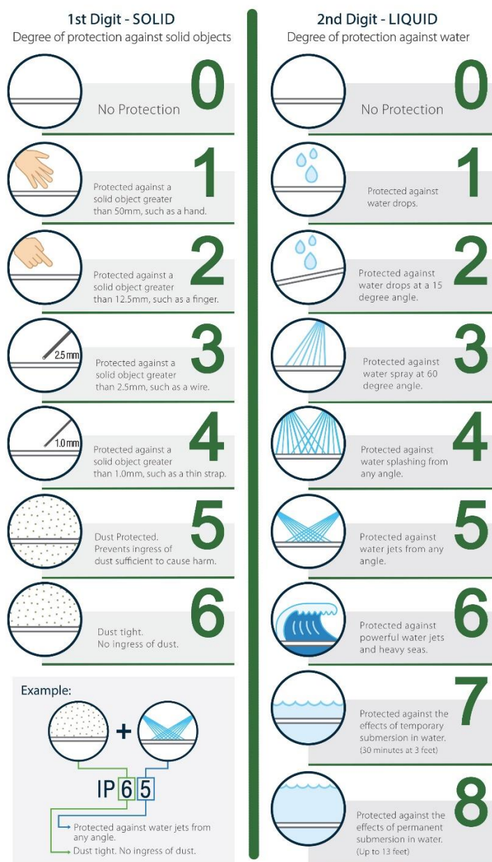
Εικόνα 69: Διάγραμμα επεξήγησης των ψηφίων του δείκτη στεγανότητας (Πηγή: http://www.veriquality.net/insights/what-is-ip-rating-for-the-led-product )
