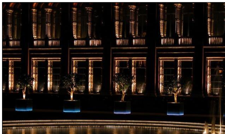
Εικόνα 10: Φωτισμός περιγράμματος (silhouetting) London, United Kingdom: Garden of the Victoria & Albert Museum (Πηγή: External lighting systems, iGuzzini, https://www.iguzzini.com/projects/project-gallery/ )
