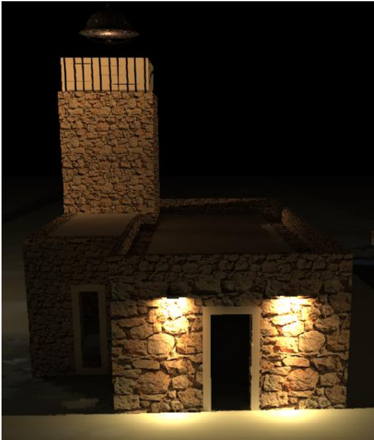
Εικόνα 92: Προσομοίωση εγκατάστασης φωτισμού με το πρόγραμμα Relux
