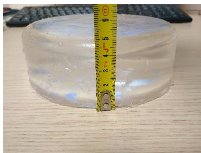
Εικόνα 2-10: Ζελέ κεριού κυλινδρικού σχήματος ύψους 5 cm για χρήση σε δοκιμές υπολογισμού ακουστικών παραμέτρων.
