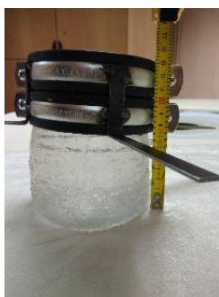
Εικόνα 2-11: Κυλινδρικό ομοίωμα μαστού από ζελέ κεριού μαζί με τη βάση στήριξης.
