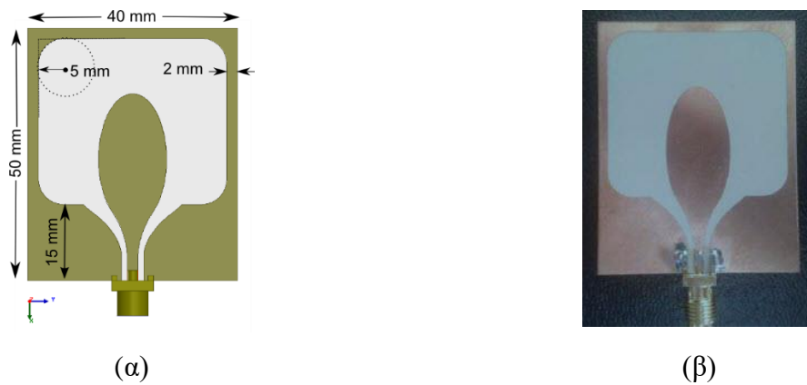
Εικόνα 3-28: Ομοεπίπεδη ελλειπτική κεραία (α) Προσομοίωση στο λογισμικό HFSS (β) Κατασκευασμένη κεραία.
