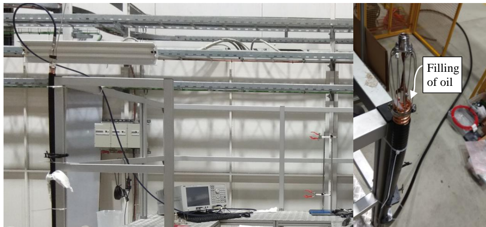
Εικόνα 78: The setup for the impedance measurement
