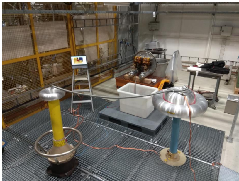
Εικόνα 34: The ‘Saleve 6’ HV test cage in b.867
