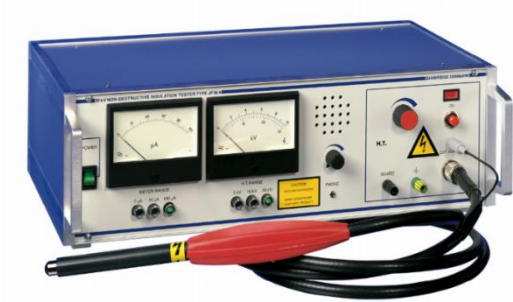
Εικόνα 38: 30 kV Non-Destructive Insulation Tester
