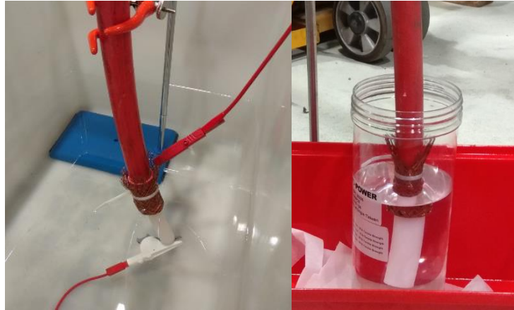
Εικόνα 74: Cable ends in oil
