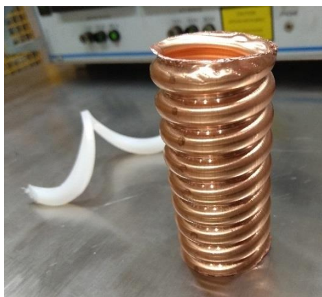
Εικόνα 84: The actual spirally corrugated OC and the helical spacer
