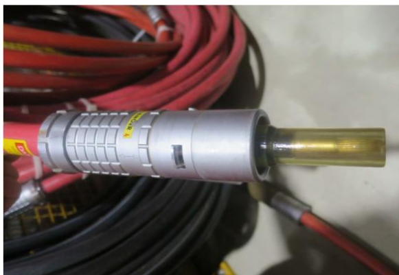
Εικόνα 21. LEMO HT50 σύνδεσμος, σε χρήση για συστήματα τάσεων έως 40kV [19]
