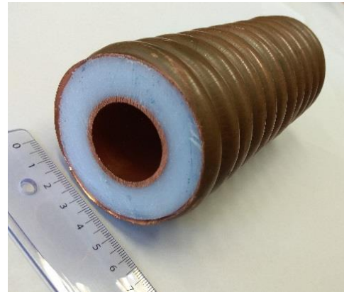
Εικόνα 52: The Kabelwerke Brugg SF 6 gas filled cable
