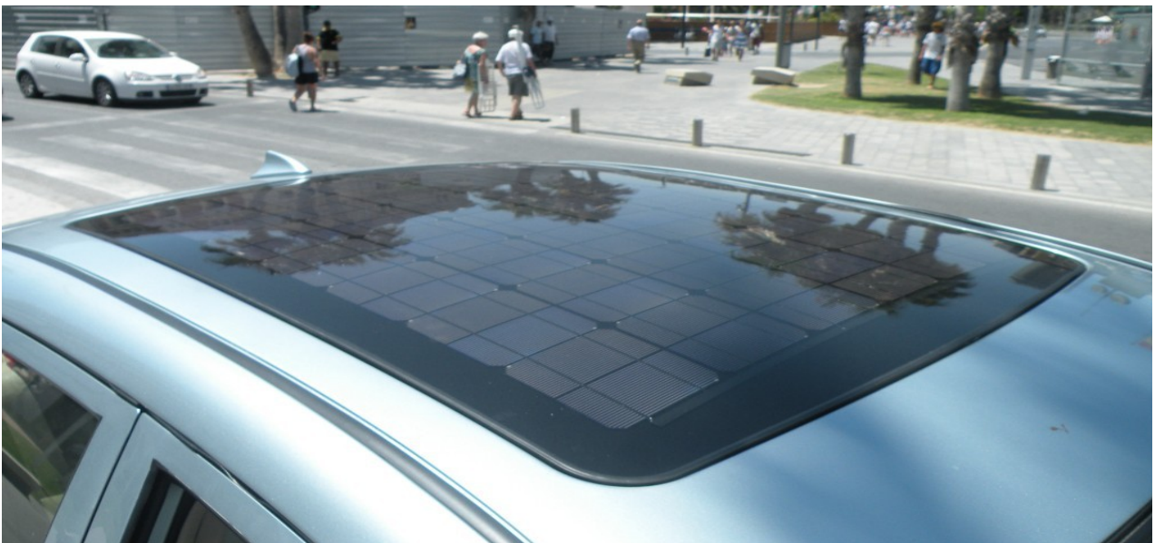
Σχήμα 2.11 Ηλιακά πάνελ στο αμάξωμα
