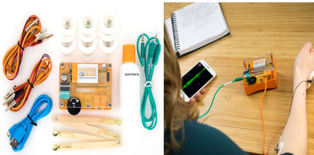
Εικόνα 17: Πλακέτα Ηλεκτρομυογράφου (EMG) – Muscle SpikerBox Pro (πηγή [70])
