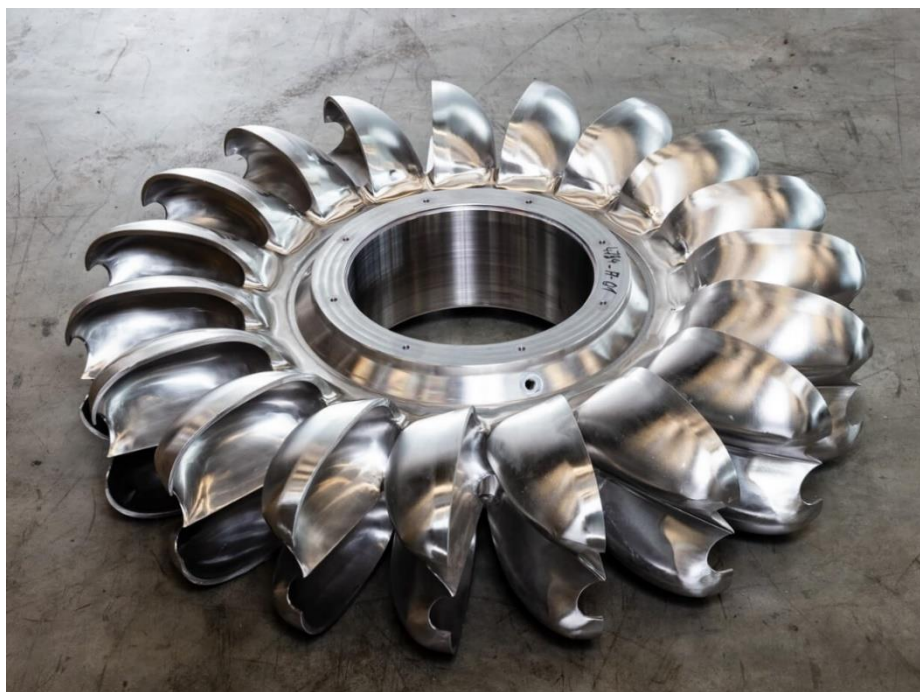
Εικόνα 3.4.4 Runner Υδροστροβίλου Pelton εταιρίας Geppert με 19 σκαφίδια [40]
