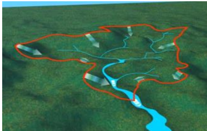
Εικόνα 2.2.1 Υδροκρίτης μίας υδρολογικής λεκάνης απορροής [16]
