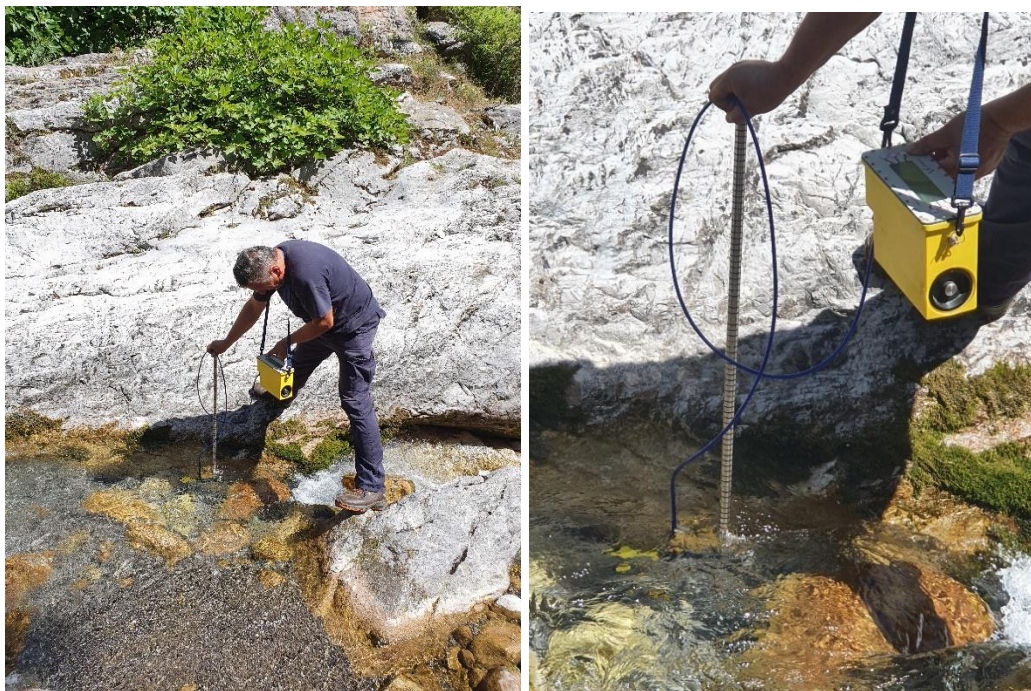
Εικόνα 3.1.3 Μέτρηση παροχής με μυλίσκο στο ρέμα Ξεριές
