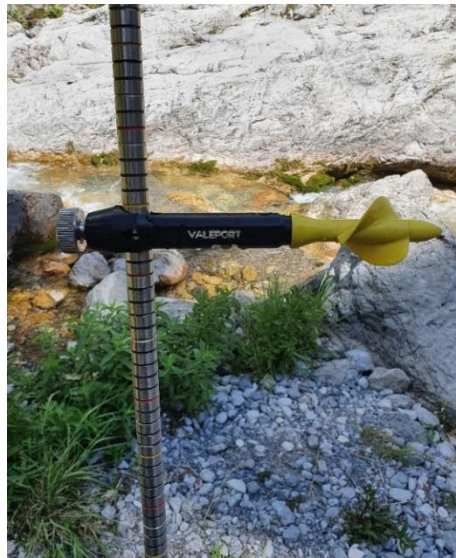
Εικόνα 3.1.2 Μυλίσκος μάρκας Valeport τύπου BFM002 που χρησιμοποιήθηκε για τις μετρήσεις
