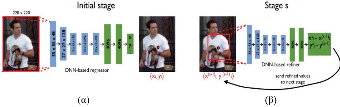
Εικόνα 9: (α) Σχηματική προβολή της παλινδρόμησης στάσης με βάση τα DNN. Οπτικοποιούμε τα επίπεδα του δικτύου με αντίστοιχες διαστάσεις τους, όπου τα συνελκτικά επίπεδα είναι με μπλε χρώμα, ενώ τα πλήρως συνδεδεμένα είναι με πράσινο χρώμα. (β) Στο στάδιο s , εφαρμόζεται μια τελειοποίηση της παλινδρόμησης σε μία δευτερεύουσα εικόνα για να βελτιώσει μια πρόβλεψη από το προηγούμενο στάδιο, Πηγή: deepai.org
