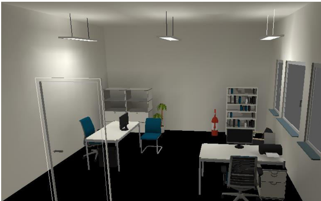
Εικόνα 7.7: Φωτισμός Γραφείων Μισθοτροφοδοσίας (Φωτιστικά Regiolux)
