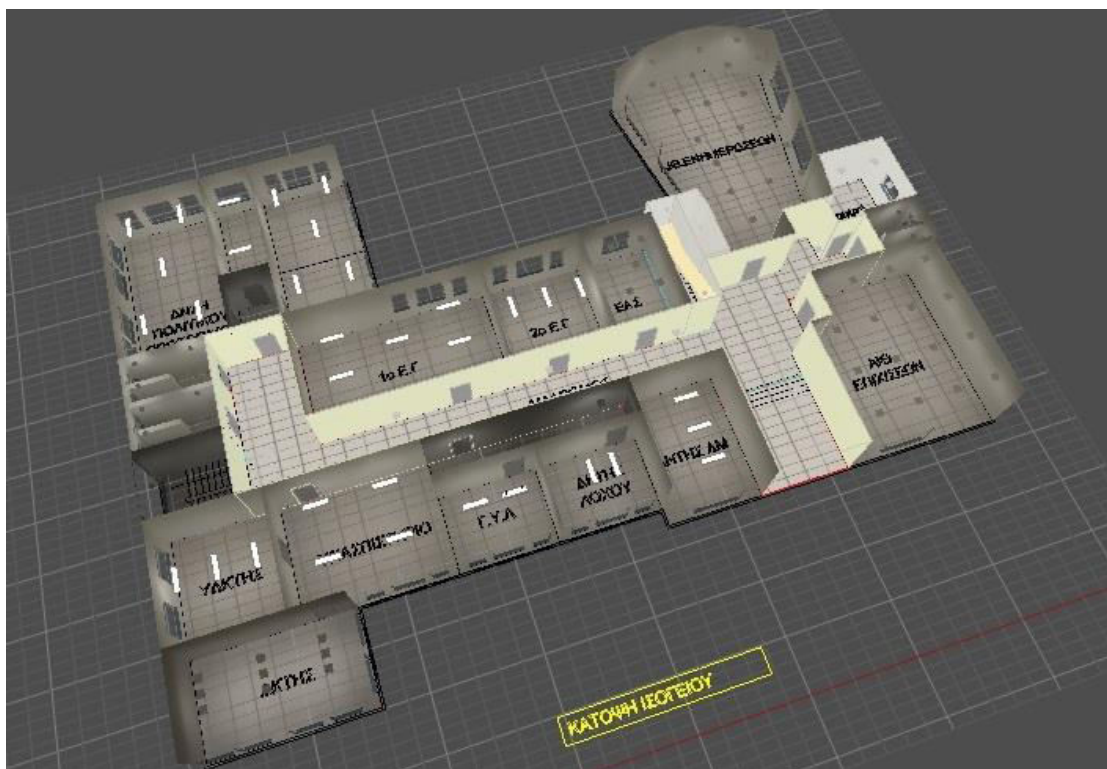
Εικόνα 7.15: Προσομοίωση Φωτισμού Ισογείου με το Relux
