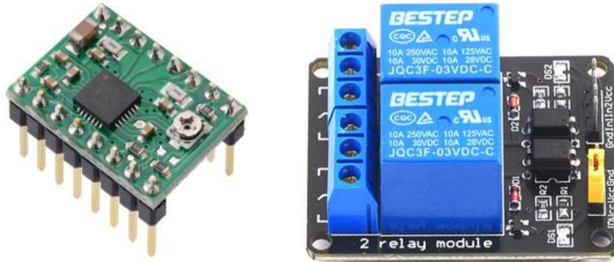
Σχήμα 4.4 Πλακέτα οδηγού βηματικού μοτέρ (αριστερά) και πλακέτα σύνδεσης/αποκοπής κυκλώματος οδηγού του βηματικού μοτέρ (δεξιά)
