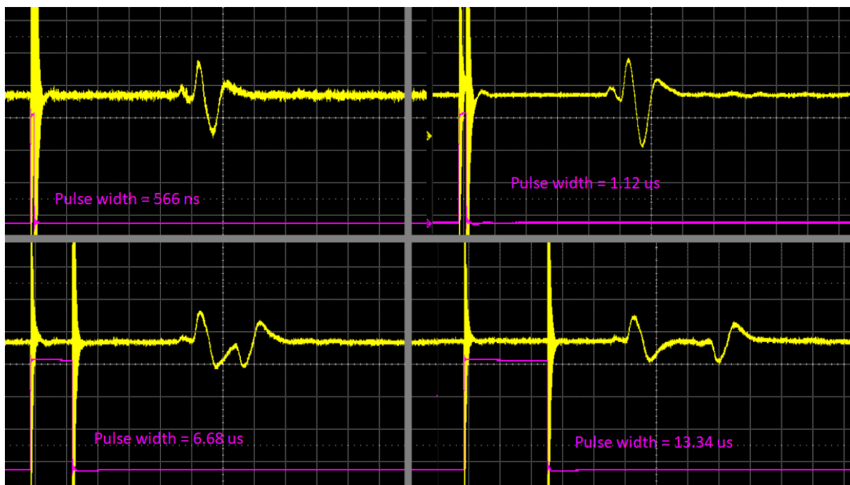
Σχήμα 4.9 Απεικόνιση του σήματος εξόδου για διαφορετικό εύρος παλμού διέγερσης
