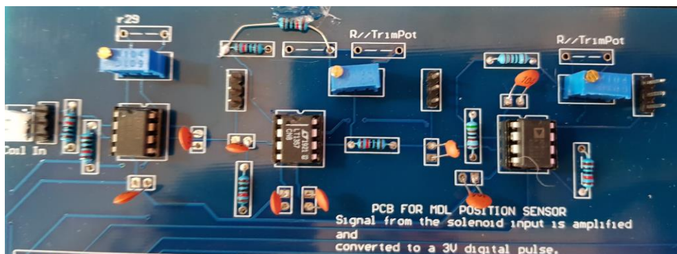
Σχήμα 0.24 Κύκλωμα λήψης σε PCB ύστερα από την συγκόλληση των στοιχείων του
