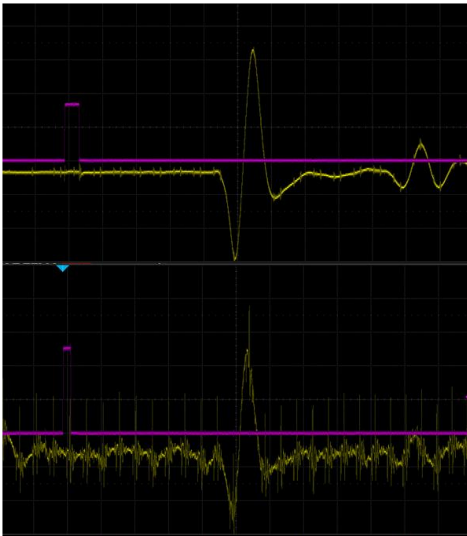
Σχήμα 5.8 Ανιχνεύσιμος παλμός στο πηνίο λήψης χωρίς παρεμβολές (πάνω) και με παρεμβολές από την λειτουργία βηματικού μοτέρ (κάτω)
