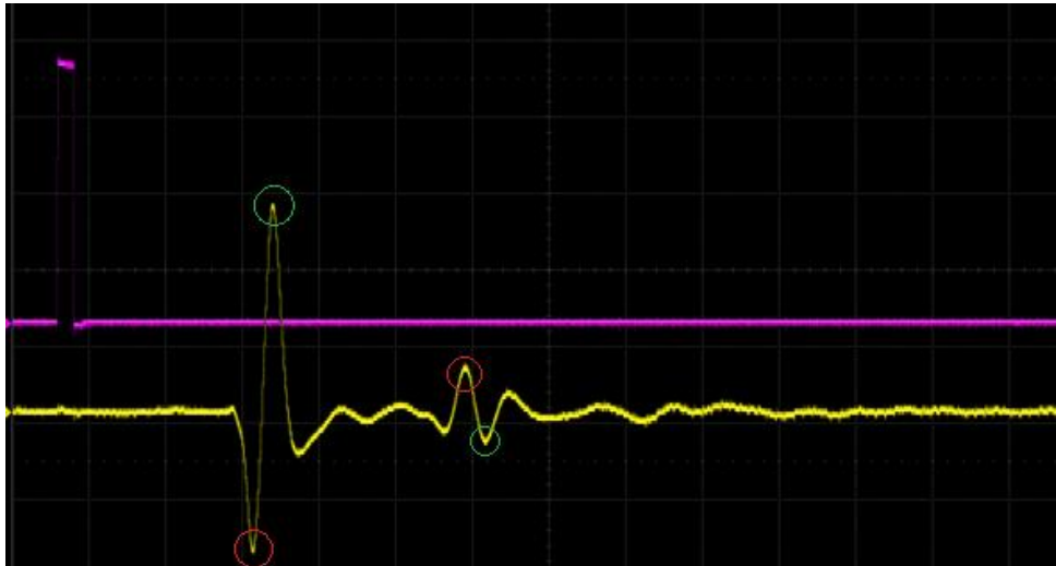
Σχήμα 4.14 Απεικόνιση στον παλμογράφο του ανιχνευόμενου και του ανακλώμενου παλμού, με επισήμανση της αναστροφής των κορυφών του ανακλώμενου παλμού
