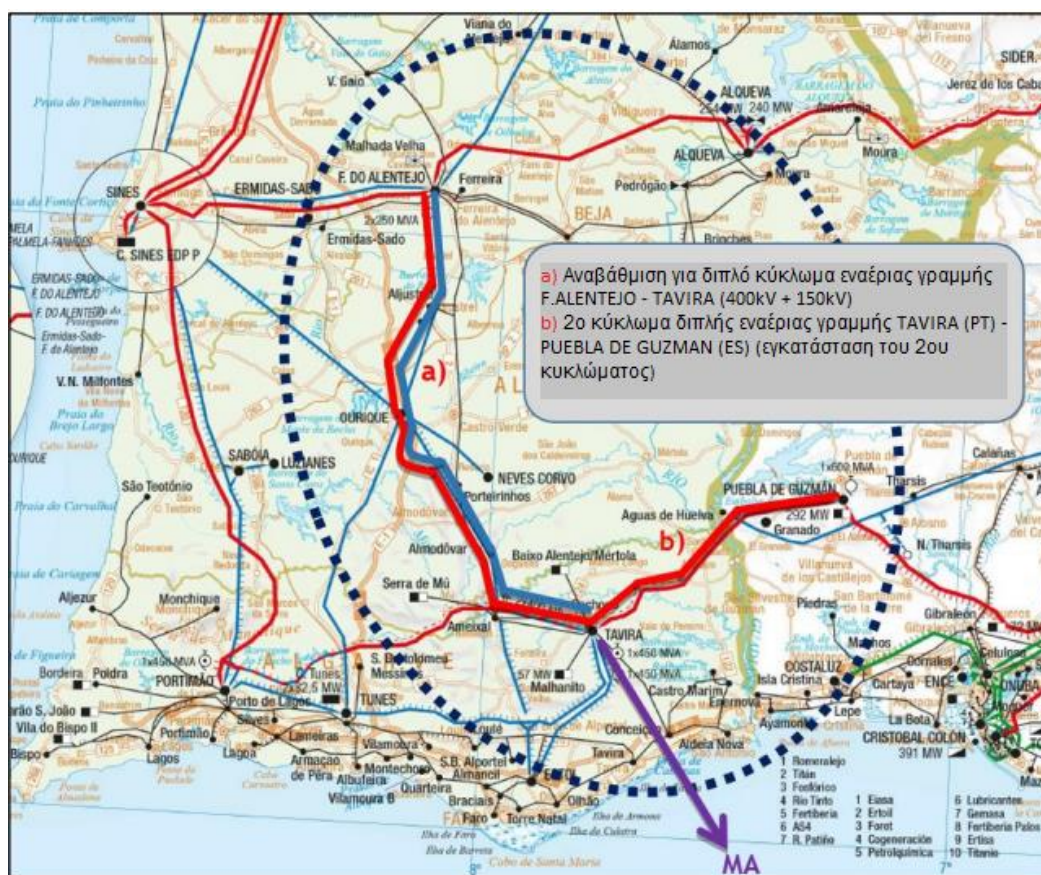
Σχήμα 16: Εσωτερικές ενισχύσεις στην Πορτογαλία που εξετάστηκαν προκειμένου να εξυπηρετήσουν τη ροή 1000MW μεταξύ Πορτογαλίας και Μαρόκου. (Πηγή: Med-TSO, 2014a)
