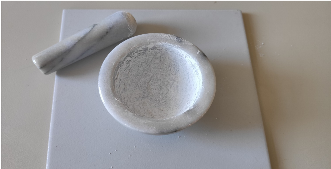
Φωτογραφία 24: Το σκεύος λείανσης κονιάματος που χρησιμοποιήθηκε στη περίπτωση της τιτανίας.
