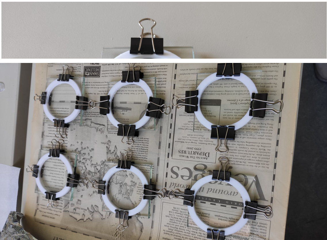
Φωτογραφία 22: Καλούπια που χρησιμοποιήθηκαν για τη κατασκευή των δοκιμών
