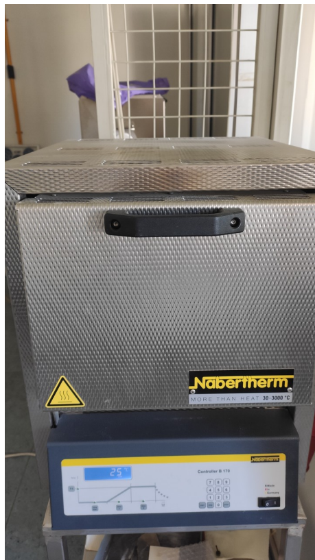
Φωτογραφία 25: Ο φούρνος απο την εταιρία nabertherm που χρησιμοποιήθηκε στη περίπτωση της τιτανίας.
