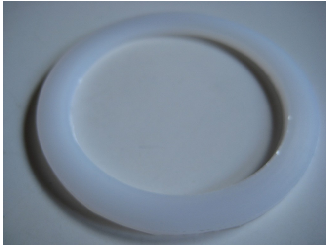
Φωτογραφία 20: Κυλινδρικό καλούπι. (Το συγκεκριμένο κατασκευασμένο από PCV)
