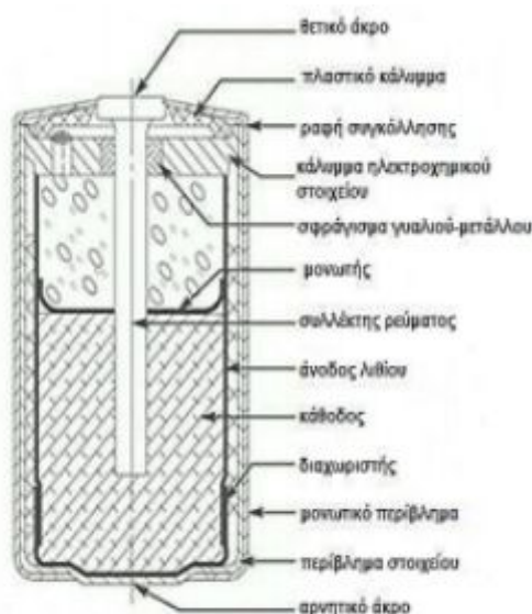
Εικόνα 6.1 Διατομή συσσωρευτή \text{Li}/\text{SOCl}_2 [20]
