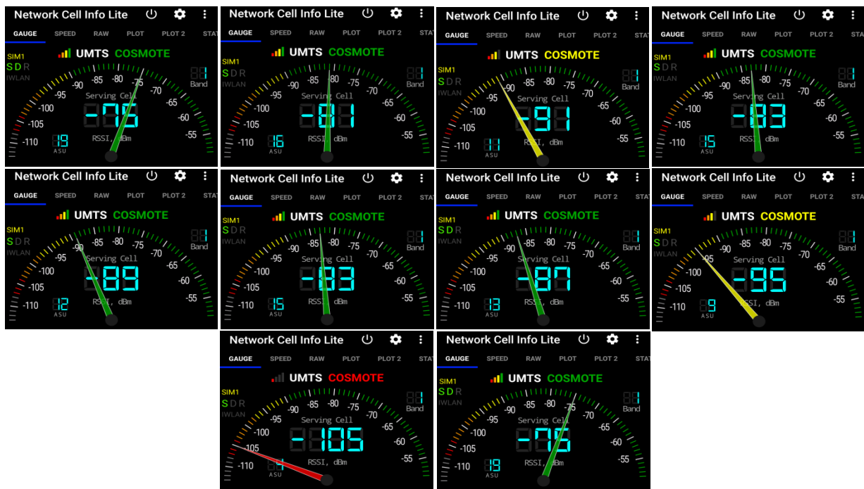
Εικόνα 34: Μετρήσεις 10 Σημείων Στο 3G (Network Cell Info Lite)
