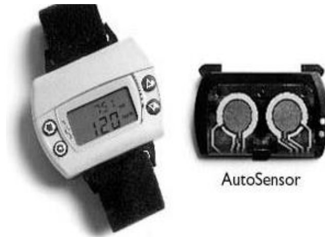
Εικόνα 2.8: Η συσκευή Cygnus GlucoWatch (αριστερά) και ο αισθητήρας γλυκόζης (δεξιά).
