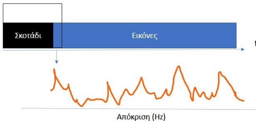
Σχήμα 31: Αναπαράσταση του πρώτου δείγματος εκπαίδευσης. Αποτελείται από μία εικόνα και το διάνυσμα με τις αποκρίσεις σε αυτήν όλων των κυττάρων μαζί με 39 μαύρα καρέ. Μετατοπίζοντας το κυλιόμενο παράθυρο προς τα δεξιά, δημιουργούμε τα υπόλοιπα δείγματα.
