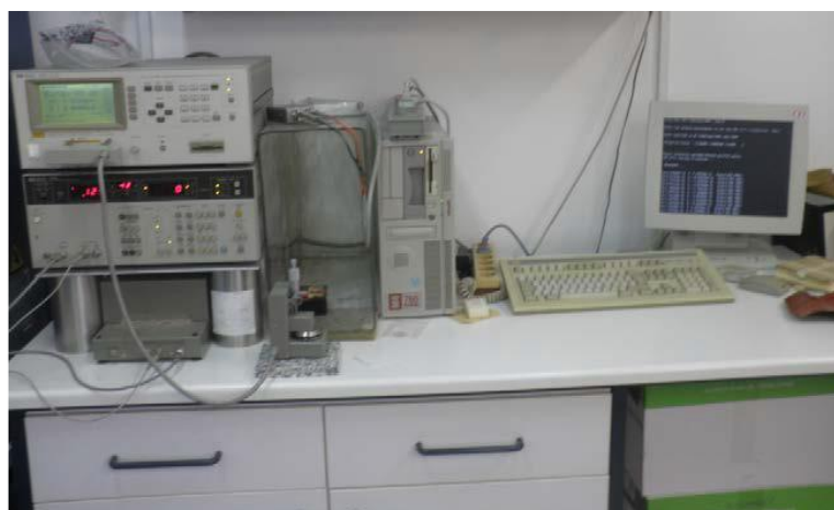
Εικόνα 5.12 Ολόκληρη η διάταξη μέτρησης των διηλεκτρικών μεγεθών στις χαμηλές συχνότητες.
