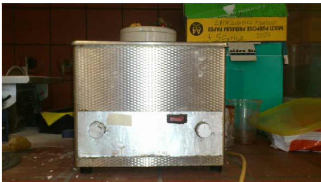
Εικόνα 5.6 Λουτρό υπερήχων Elma Transsonic T460
