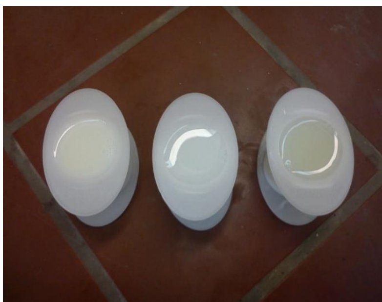
Εικόνα 5.3 Πλαστικά καλούπια κατά τη διάρκεια της στερεοποίησης του υλικού.
