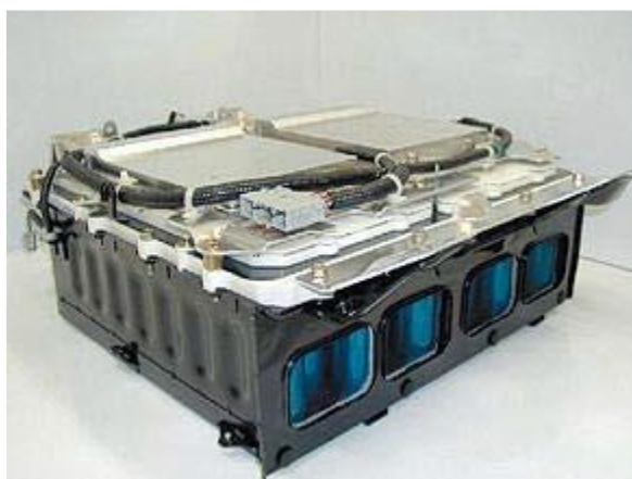
Εικόνα 2.5 Υπερ- πυκνωτής (ultra- capacitor) με διπλάσια χωρητικότητα σε σύγκριση με τους συνηθισμένους, χάρη στη χρήση νανο - σύνθετων υλικών.
