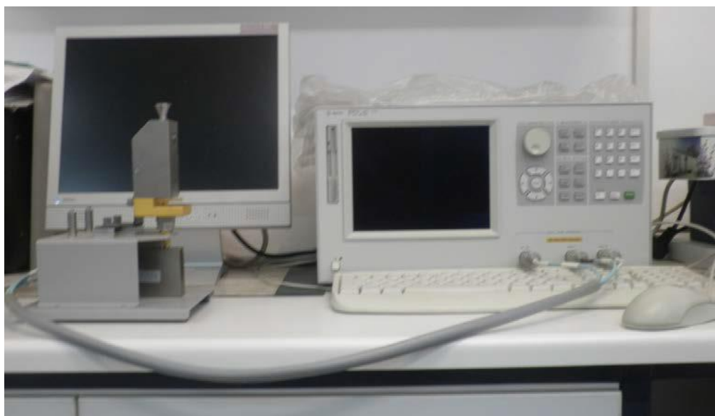
Εικόνα 5.15 Ολόκληρη η διάταξη μέτρησης των διηλεκτρικών μεγεθών στις υψηλές συχνότητες.
