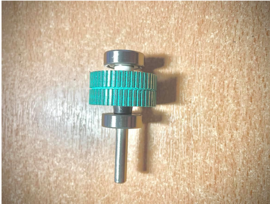
Εικόνα 3 ρότορας βηματικού μοτέρ NEMA 17
