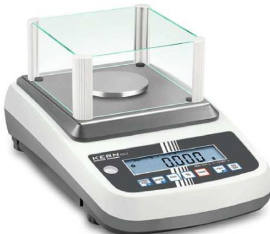
Εικόνα 4.36 Ο ζυγός ακριβείας KERN του εργαστηρίου υψηλών τάσεων και ηλεκτρικών μετρήσεων του ΕΜΠ
