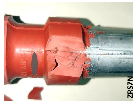
Εικόνα 4.32 Έλεγχος σωστής συγκόλλησης του συνθετικού περιβλήματος στους ακροδέκτες
