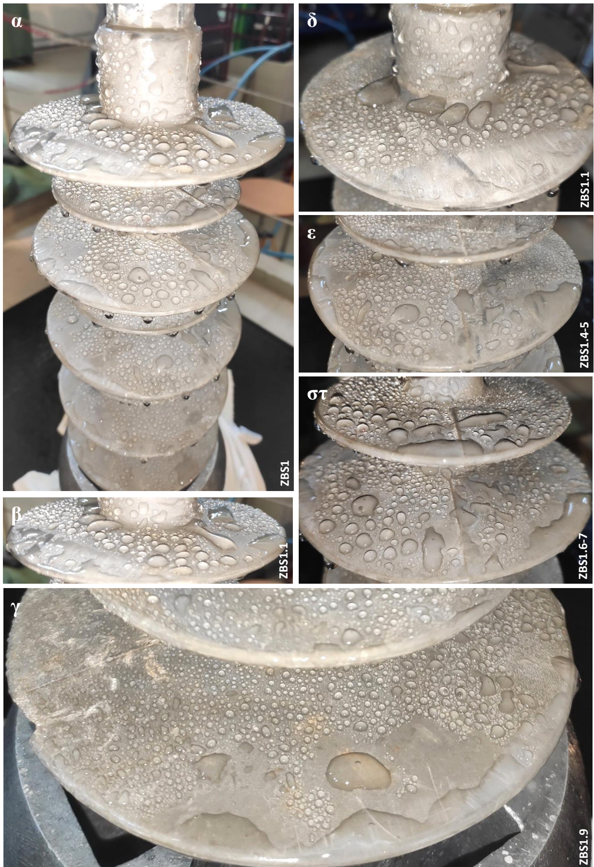
Εικόνα 4.11 Μετρήσεις υδροφοβικότητας του μονωτήρα ZBS1
