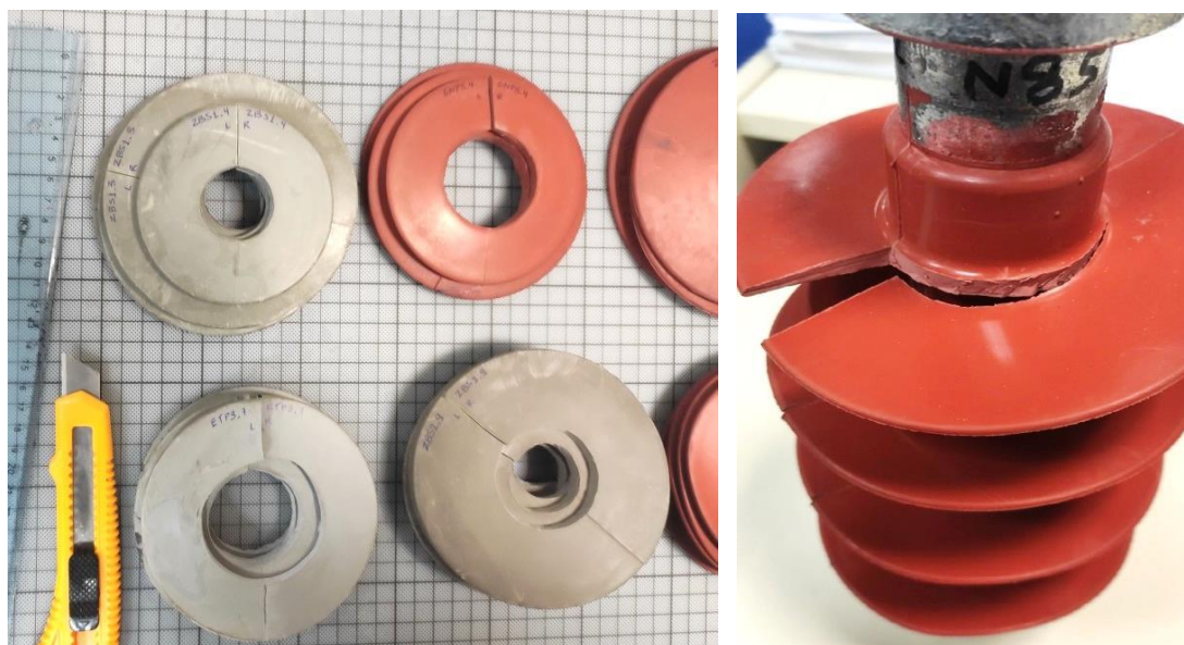
Εικόνα 4.35 Αφαίρεση των υπό μελέτη κυαθίων από τους συνθετικούς μονωτήρες
