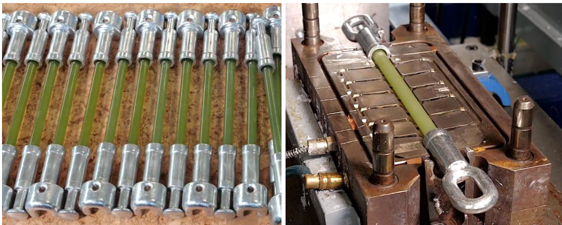
Εικόνα 1.8 Ακροδέκτες ενσωματωμένοι στους πυρήνες (αριστερά) πριν το στάδιο της χύτευσης του ελαστομερούς περιβλήματος (δεξιά) [92]
