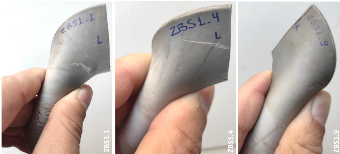
Εικόνα 4.9 Τσάκιση των κυαθίων του ZBS1
