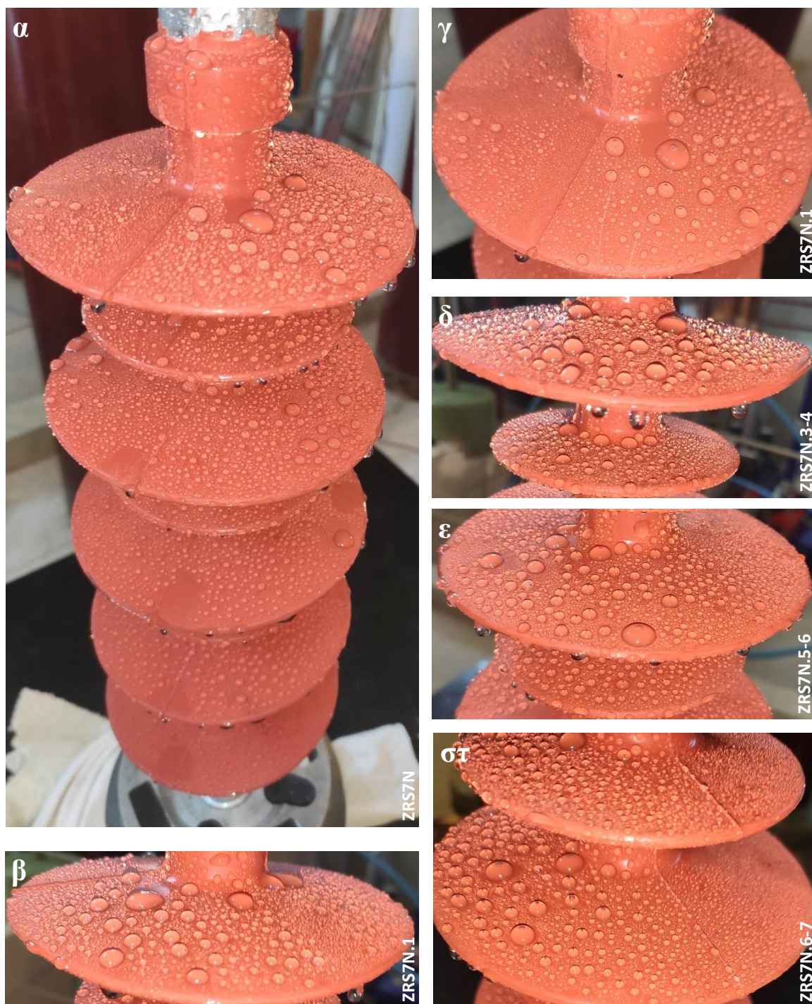
Εικόνα 4.33 Δοκιμή υδροφοβικότητας στον συνθετικό μονωτήρα ZRS7N
