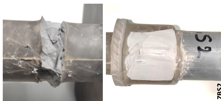
Εικόνα 4.14 Δοκιμή σωστής συγκόλλησης περιβλήματος στον μονωτήρα
