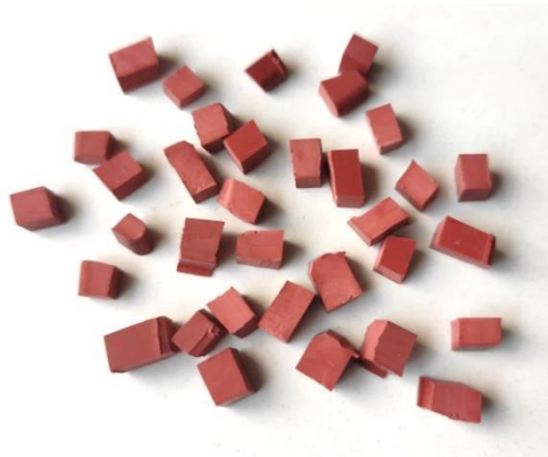
Εικόνα 3.4 Τα κομμάτια από το δοκίμιο για τη μέθοδο Β στις κατάλληλες διαστάσεις
