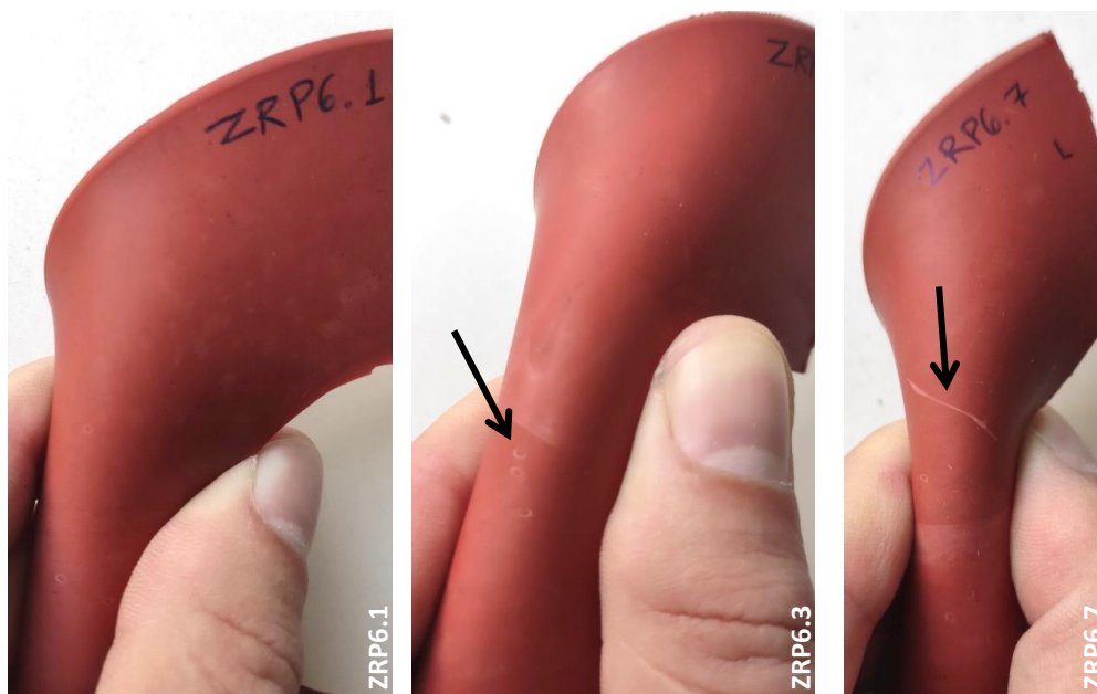
Εικόνα 4.29 Τσάκιση των κυαθίων του μονωτήρα ZRP6
