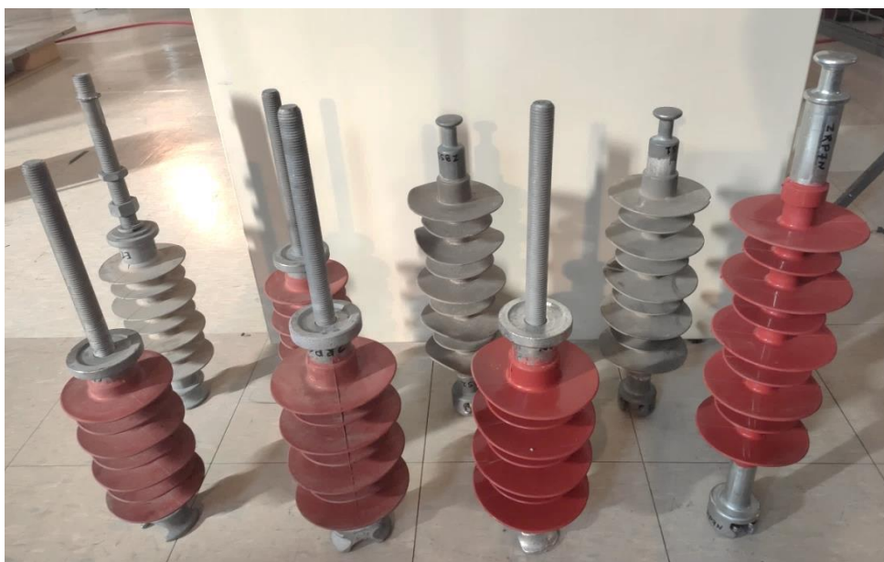
Εικόνα 4.2 Οι μονωτήρες στους οποίους θα γίνουν οι μετρήσεις
