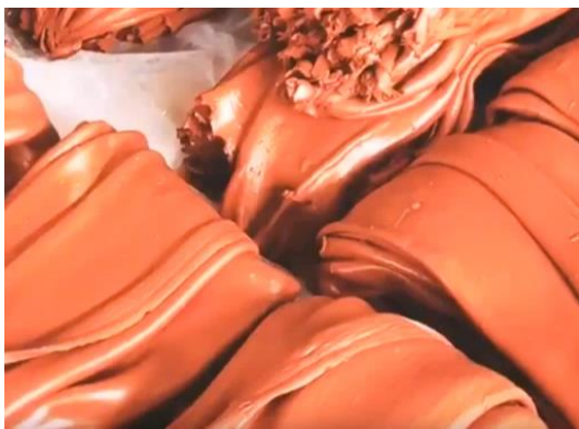
Εικόνα 1.11 Ελαστομερές σιλικόνης πριν το βουλκανισμό (αριστερά) και κατά τη χύτευσή του (δεξιά) [20]
