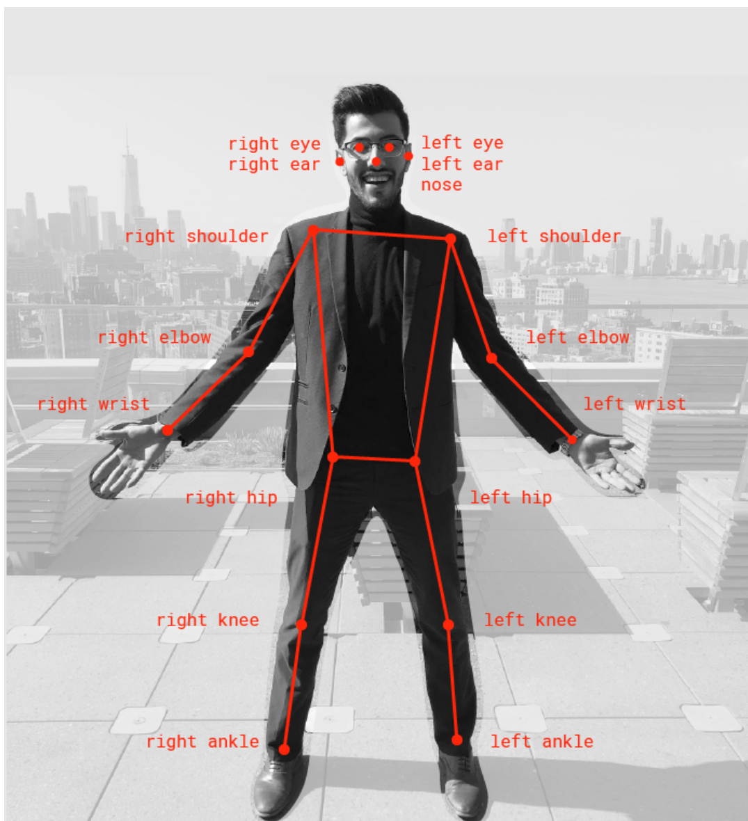
Σχήμα 5.7: Αναπαράσταση των σημείων-κλειδιών μιας φιγούρας του PoseNet
