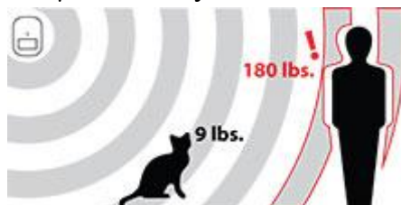
Εικόνα 3-3 Ενεργοποίηση αισθητήρα ανάλογα με τα κιλά του οργανισμού που διέρχεται από την εμβέλεια του αισθητήρα
