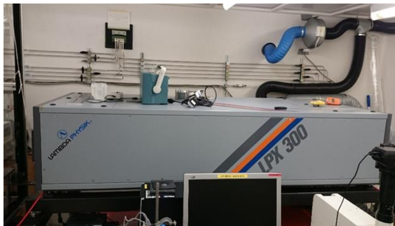
Εικόνα 38: Φωτογραφία laser διέγερσης που χρησιμοποιήθηκε για την κατασκευή νανοκρυστάλλων.
