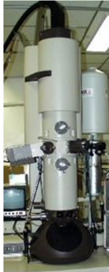
Εικόνα 53: Εικόνα του μικροσκοπίου διέλευσης ηλεκτρονίων (TEM) τύπου Philips CM20, το οποίο χρησιμοποιείται για το δομικό χαρακτηρισμό των παρασκευασθεισών δομών. Με το συγκεκριμένο μικροσκόπιο έγινε παρατήρηση κάθετης τομής στοιχείου μνήμης, καθώς επίσης και παρατήρηση του τρόπου με τον οποίο είναι διατεταγμένα στον χώρο, τα διάφορα στρώματα των παρασκευασθεισών δομών.
