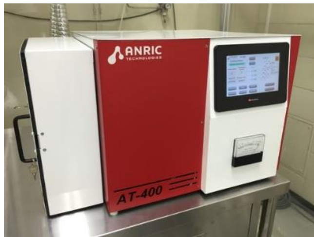
Εικόνα 47: ALD που χρησιμοποιήθηκε για την κατασκευή οξειδίου φραγής \text{Al}_2\text{O}_3 .
