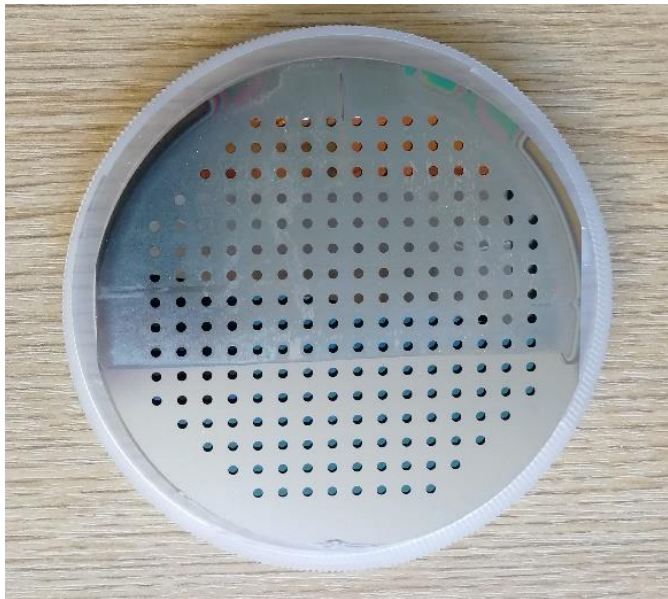
Εικόνα 48: Διάτρητη μεταλλική μάσκα για την κατασκευή της πύλης στις δομές.
