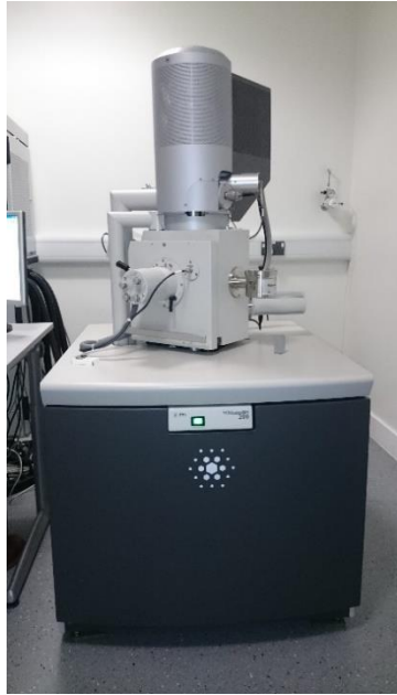
Εικόνα 52: Ηλεκτρονικό μικροσκόπιο σάρωσης εκπομπής πεδίου, που χρησιμοποιείται για το δομικό χαρακτηρισμό των νανοκρυστάλλων.
