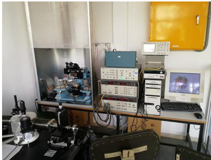
Εικόνα 75: Φωτογραφία των μετρητικών οργάνων που χρησιμοποιήθηκαν για τον ηλεκτρικό χαρακτηρισμό των δομών μνήμης.
