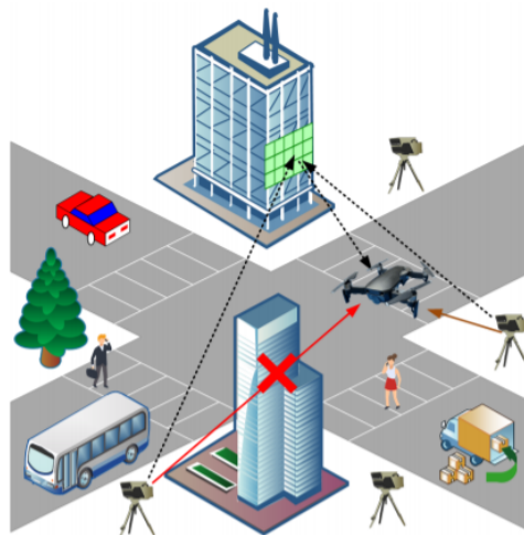
Σχήμα 2.4: UAV-επικοινωνίες υποβοηθούμενες από το RIS. Πηγή Αναφοράς: [4]
