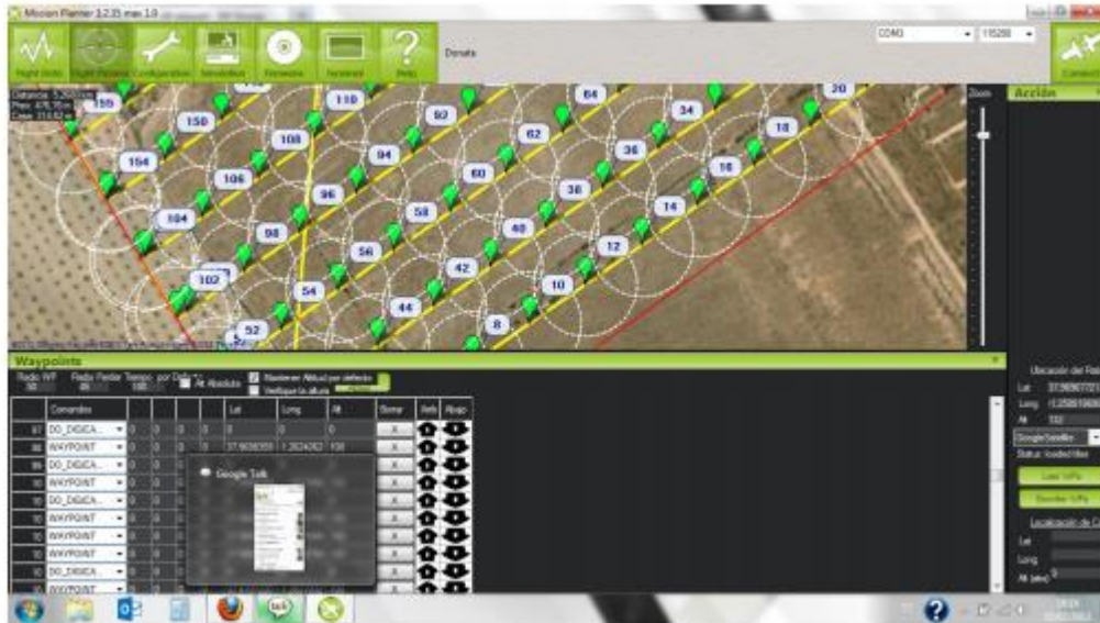
Εικόνα 2 Προγραμματισμένη πορεία πλοήγησης για την αξιολόγηση του εδάφους στο λογισμικό ανοιχτού κώδικα APM Planner.
