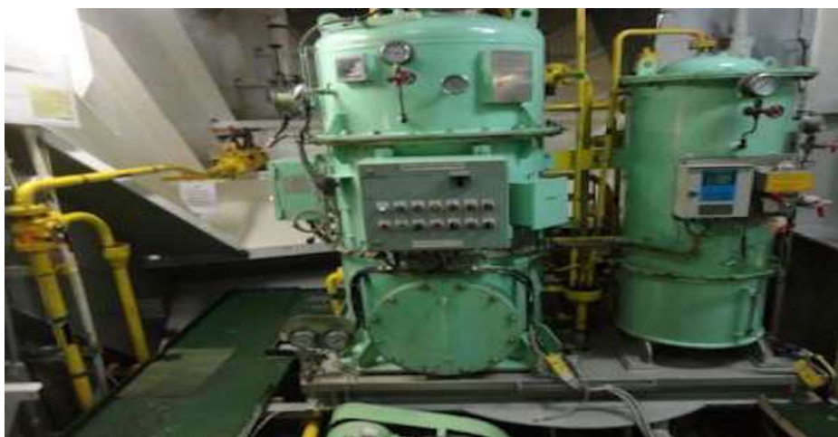
Σχήμα 6.64 Διαχωριστής νερού-ελαίων εντός πλοίου.
