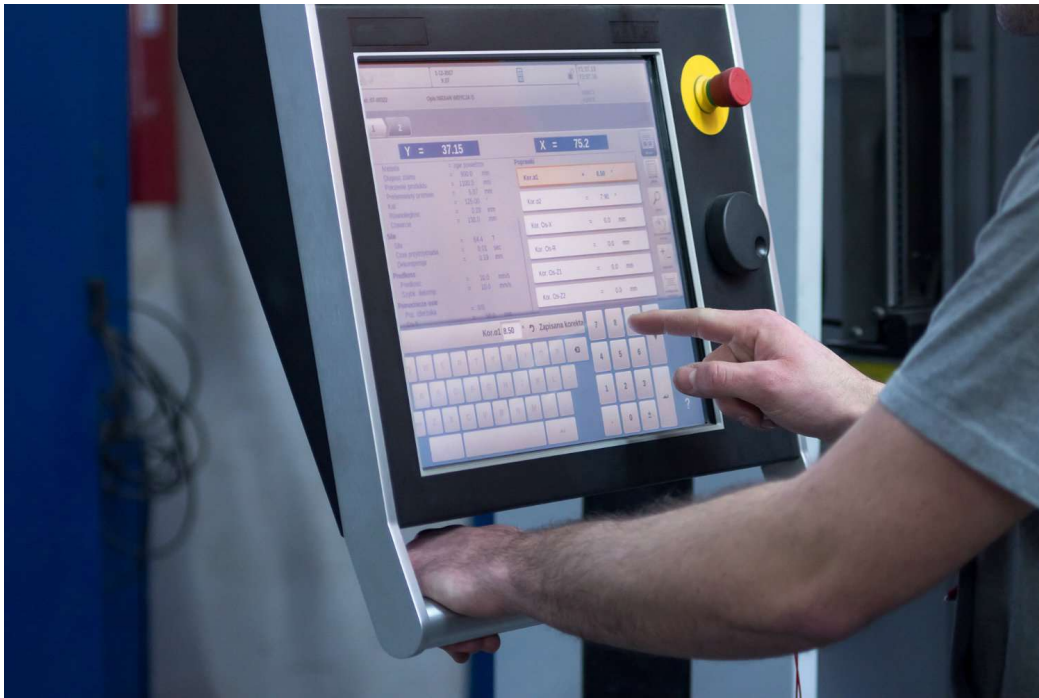
Σχήμα 4.42 Οθόνη αφής HMI. Οι διαμόρφωση των λειτουργιών, της οπτικοποίησης και των ενδείξεων μίας διεργασίας είναι πλέον απεριόριστη.
