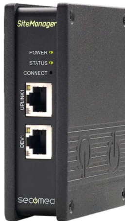
Σχήμα 4.47 SiteManager βιομηχανικό Gateway.
