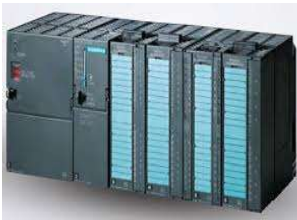
Σχήμα 2.9 α. Ένας διαμορφώσιμος λογικός ελεγκτής με κάρτες εισόδου/εξόδου.
