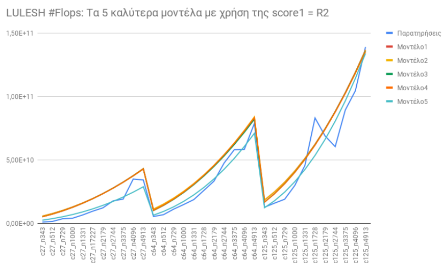
Σχήμα 4.1: Τα 5 καλύτερα μοντέλα πρόβλεψης του αριθμού των FLOPS για την εφαρμογή LULESH, με χρήση της 3.2
