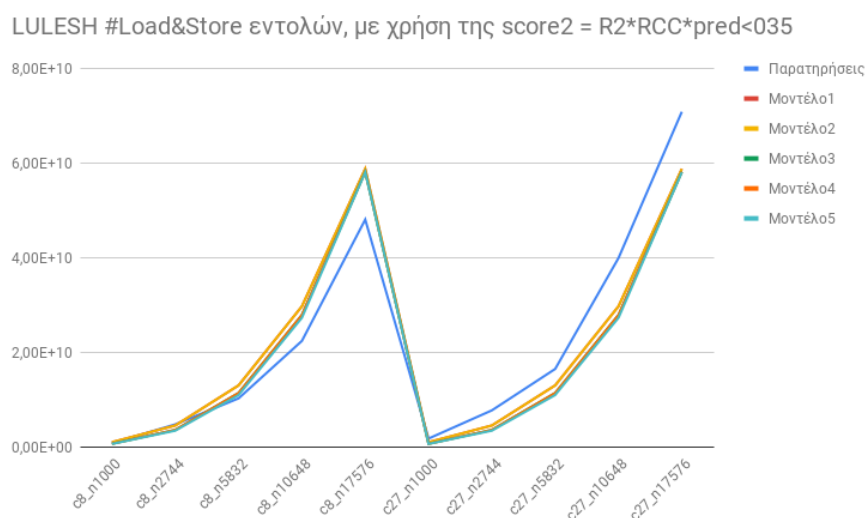
Σχήμα 4.8: Τα 5 καλύτερα μοντέλα πρόβλεψης του αριθμού των εντολών πρόσβασης στη μνήμη για την εφαρμογή LULESH, με χρήση της 3.3
