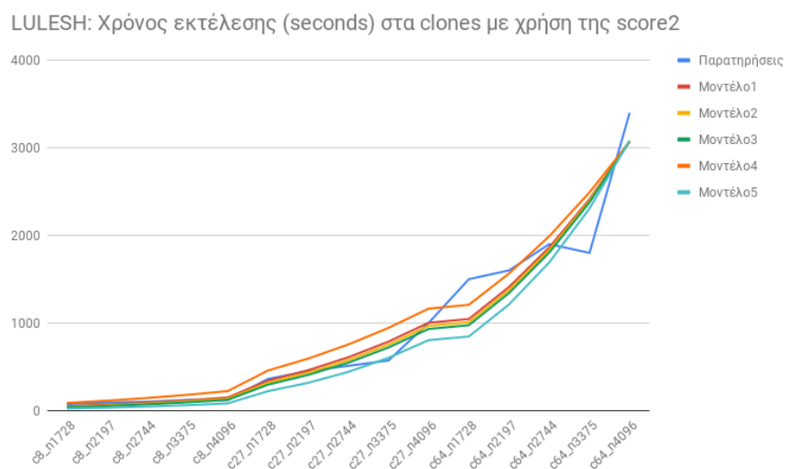
Σχήμα 5.3: Τα 5 καλύτερα μοντέλα πρόβλεψης του χρόνου εκτέλεσης για την εφαρμογή LULESH στα μηχανήματα clones, με χρήση της score2 3.3
