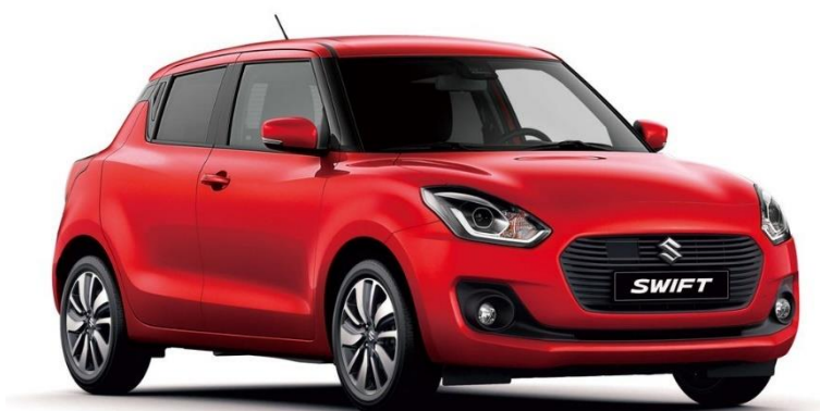
Σχήμα(2.4). Suzuki Swift με τεχνολογία Smart Hybrid και ισχύ 90hp, κατανάλωση καυσίμου μικτού κύκλου 4.1 l/100 km και εκπομπές CO 2 94g/km
