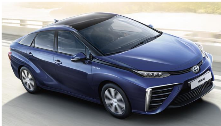
Σχήμα(2.11). Toyota Mirai με ισχύ 113 kW, εύρος οδήγησης 550 km (NEDC) και κατανάλωση 0.76kg/km [ 81]
