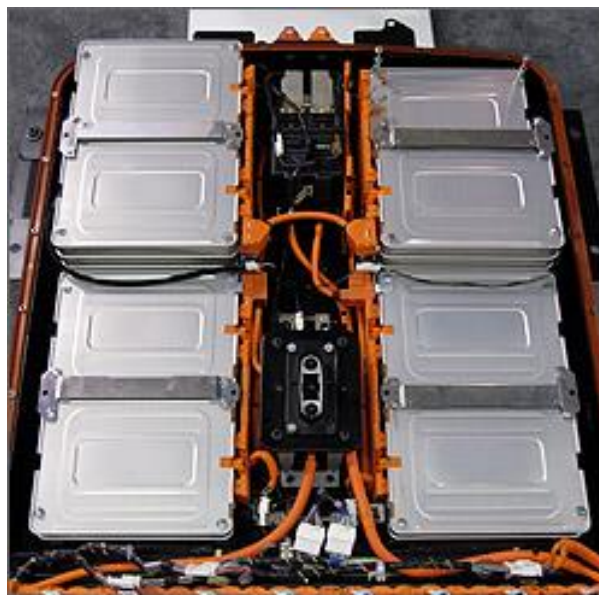
Σχήμα(2.13). Μπαταρίες λιθίου που χρησιμοποιούνται στα περισσότερα ηλεκτρικά οχήματα
