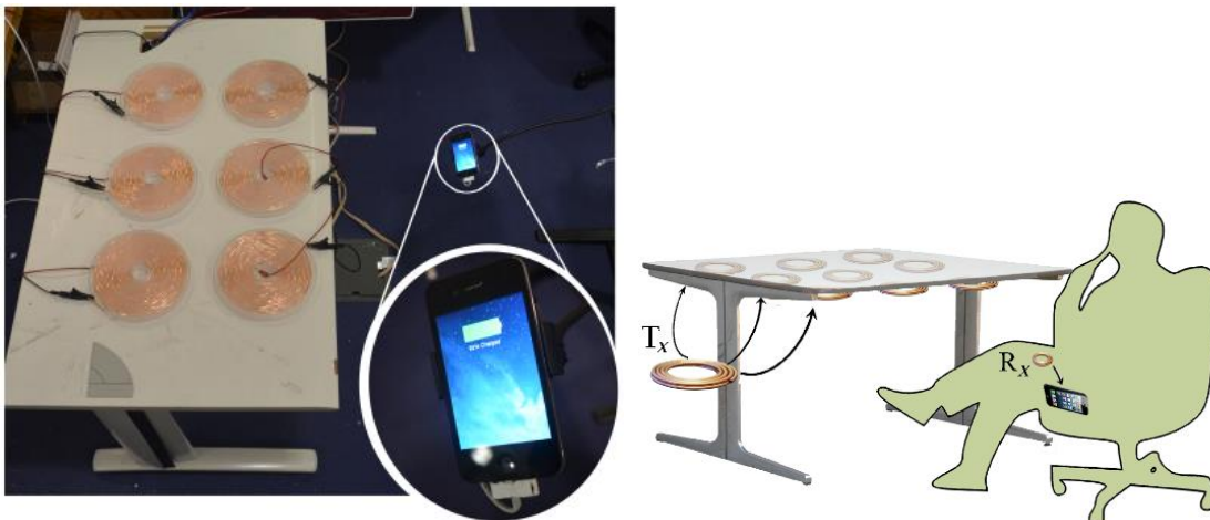
Σχήμα(1.25). Αριστερά: Πρότυπο του MagMIMO , Δεξιά: Ο πομπός αποτελείται από η όμοια τυλίγματα τοποθετημένα κάτω από την επιφάνεια ενός τυπικού γραφείου που υποθέτουμε ότι δεν είναι φτιαγμένο από αγώγιμα μέταλλα. Το πηνίο λήψης είναι ένα μικρό τύλιγμα που μπορεί να ενσωματωθεί εντός του κινητού τηλεφώνου ή στο περίβλημά του
