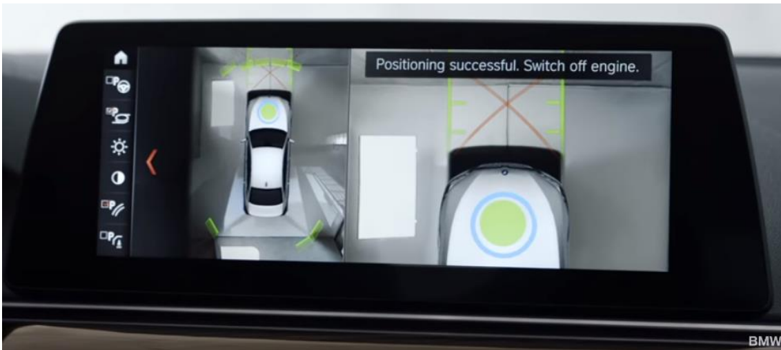
Σχήμα (1.36). Καθοδήγηση του οδηγού στη σωστή θέση στάθμευσης του οχήματος από το σύστημα μέσω αισθητήρα ανίχνευσης θέσης
