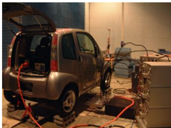
Σχήμα(1.19). Πειραματική διάταξη ασύρματης φόρτισης ηλεκτρικού αυτοκινήτου με μικροκύματα από το πανεπιστήμιο του Κίτο
