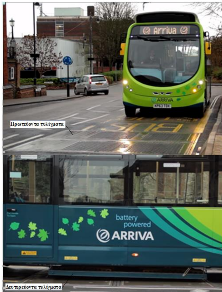
Σχήμα(1.28). Πλήρως ηλεκτρικό λεωφορείο με ασύρματη φόρτιση στο Μίλτον Κέινς
