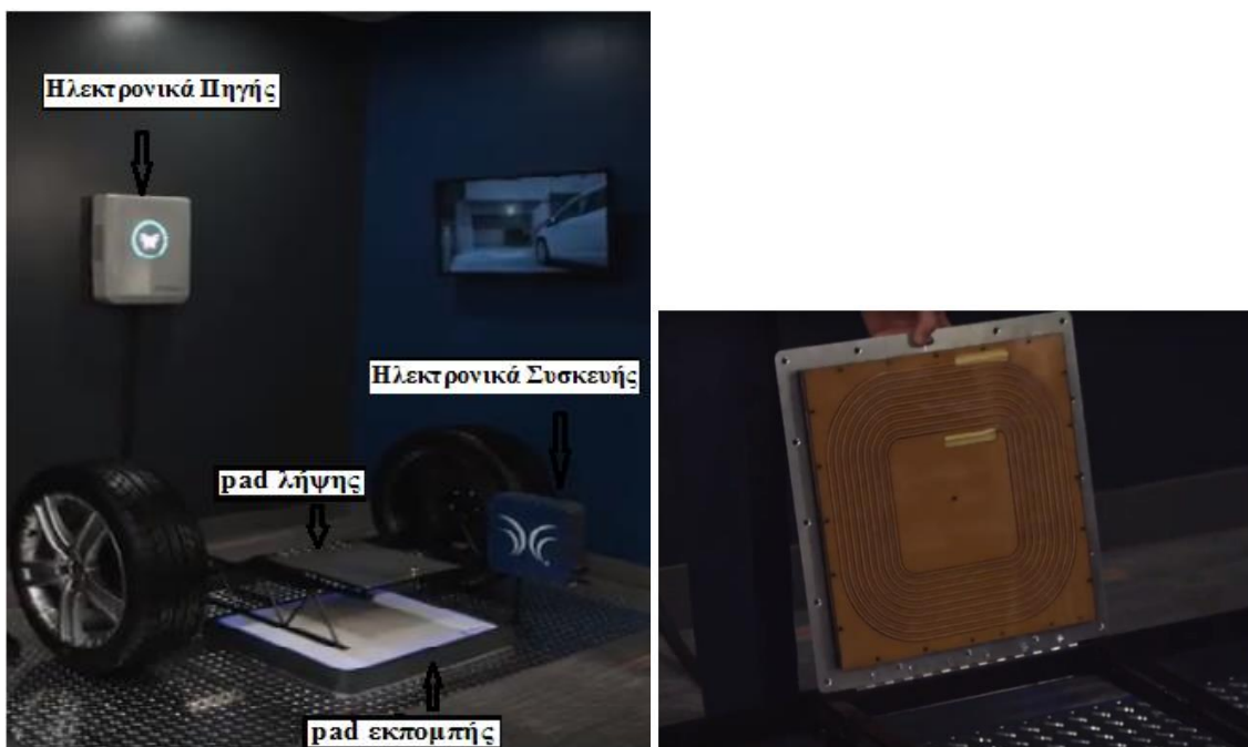
Σχήμα(1.34). Αριστερά :DRIVE 11, Δεξιά: Συντονιστής συσκευής που περιέχεται στο pad λήψης
