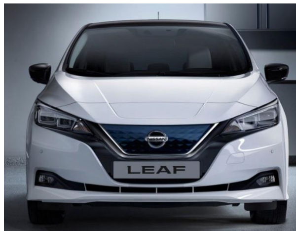
Σχήμα(2.10). Nissan Leaf με ισχύ 150 hp, αυτονομία και κατανάλωση ηλεκτρικού ρεύματος (WLTP) συνδυασμένου κύκλου 270 km και 206 Wh/km αντίστοιχα [88]
