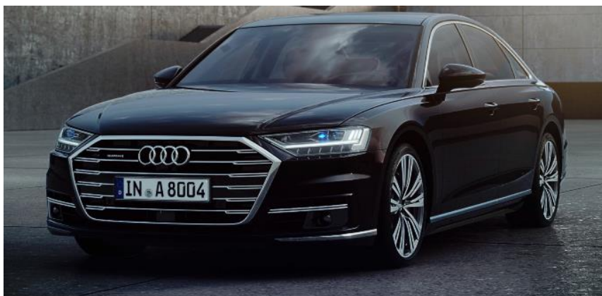
Σχήμα(2.5). Audi A8 (MHEV) με ισχύ 250 kW, κατανάλωση καυσίμου 7.8-7.5 l/ 100 km και εκπομπές CO2 152-145 g/km [79]
