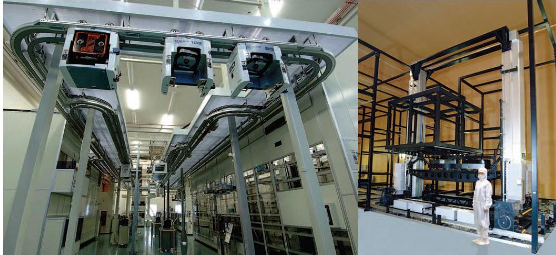
Σχήμα(1.2). Αριστερά: Σύστημα Clean Room της Daifuku, Δεξιά: Φορτωτής πλακών LCD σε Clean Room της Daifuku
