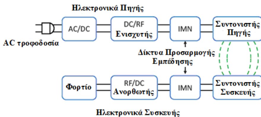
Σχήμα(1.33). Διάγραμμα βαθμίδων του συστήματος ασύρματης φόρτισης του ηλεκτρικού αυτοκινήτου με μαγνητικό συντονισμό
