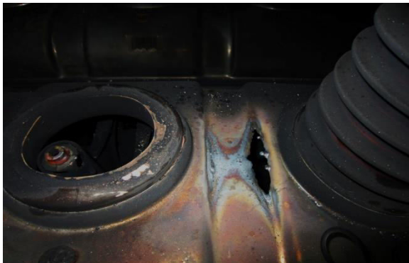
Εικόνα 92. Άνοιγμα των ηλεκτροσυγκολλήσεων στο τανκ του Διακόπτη Φορτίου, Πηγή: [14]
