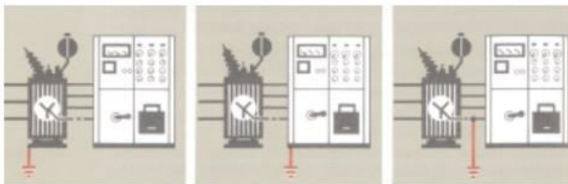
Εικόνα 84. Τα τρία Συστήματα Γειώσεων στους Υ/Σ Διανομής Πόλεως ΜΤ/ΧΤ του ΕΔΔΗΕ
