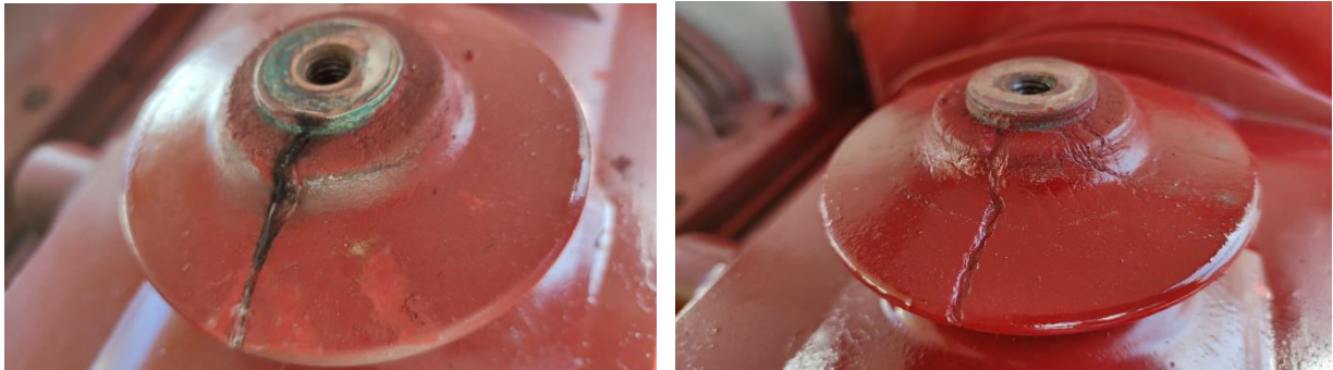
Εικόνα 89. Α. Η καταστροφή που έχει υποστεί η επιφάνεια του μονωτήρα εξαιτίας της υγρασίας Β. Προσωρινή αποκατάσταση της ζημιάς μετά από εργασίες συντήρησης (ο μονωτήρας ωστόσο αντικαταστάθηκε σε δεύτερο χρόνο), Πηγή: Προσωπικό Αρχείο
