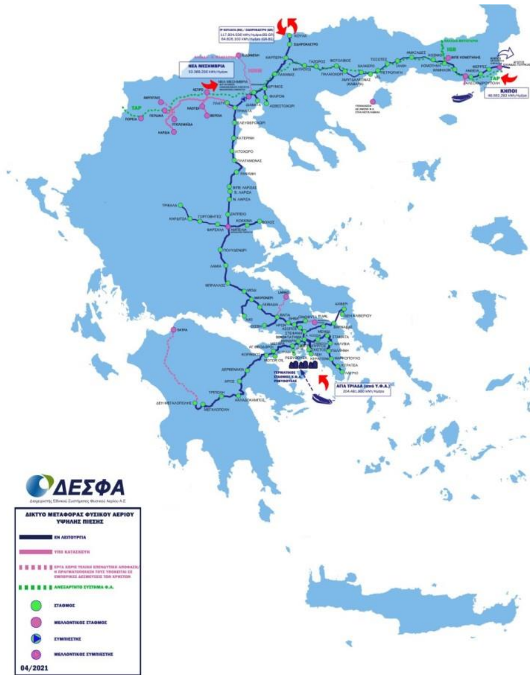
Εικόνα 5.1: Το Δίκτυο Φυσικού Αερίου της Ελλάδας Πηγή: https://www.desfa.gr/national-natural-gas-system/transmission
