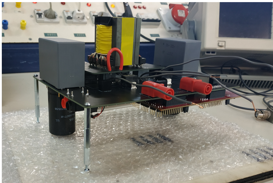
Σχήμα 7.12: Εργαστηριακή υλοποίηση νέας σχεδίασης με τον μετασχηματιστή
