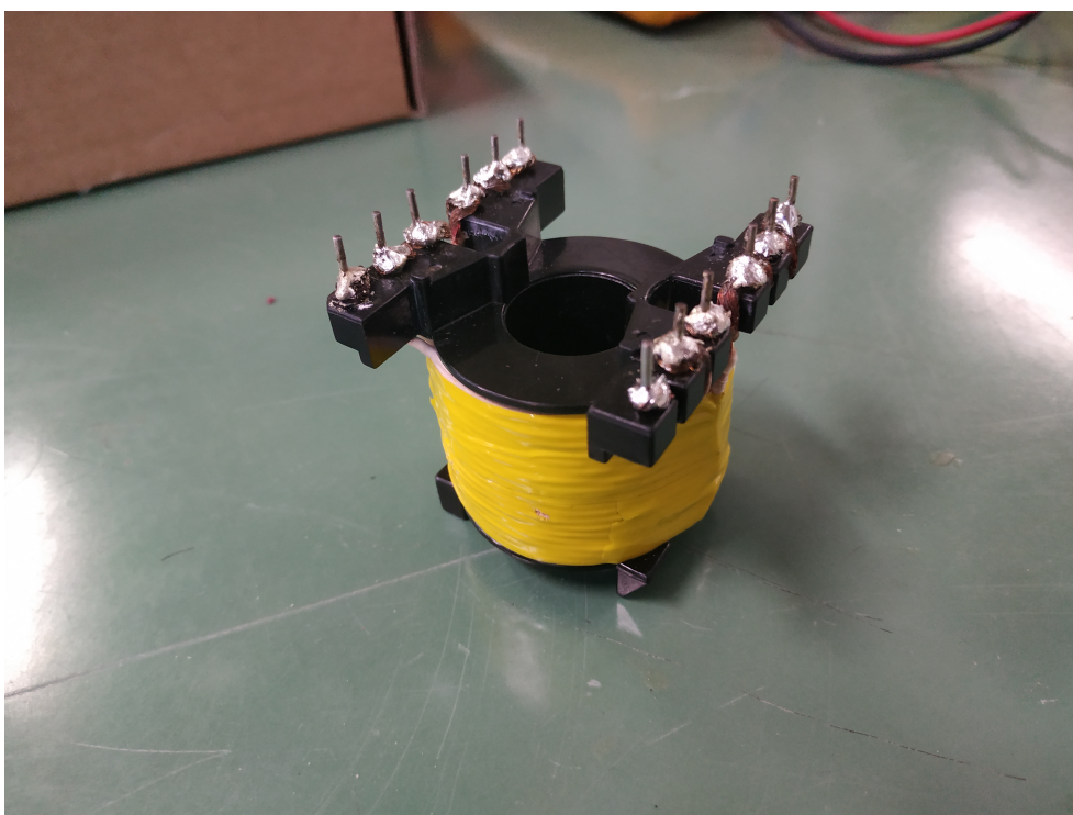
Σχήμα 5.14: Τυλιγμένη μπομπίνα με κολλημένα τερματικά
