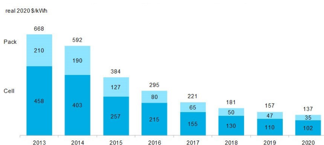
Εικόνα 2.2: Σταθμισμένη μέση τιμή συστοιχίας μπαταριών (Pack) και κυττάρου μπαταρίας (Cell) [5]
