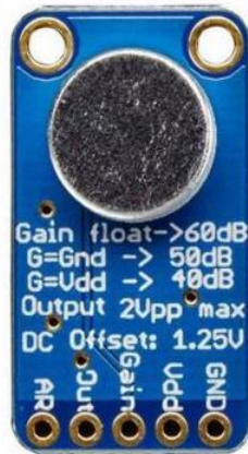
Εικόνα 33: Το μικρόφωνο MAX9814. Ευδιάκριτα είναι τα pins για την τροφοδοσία και τη ρύθμιση του κέρδους.[49]
