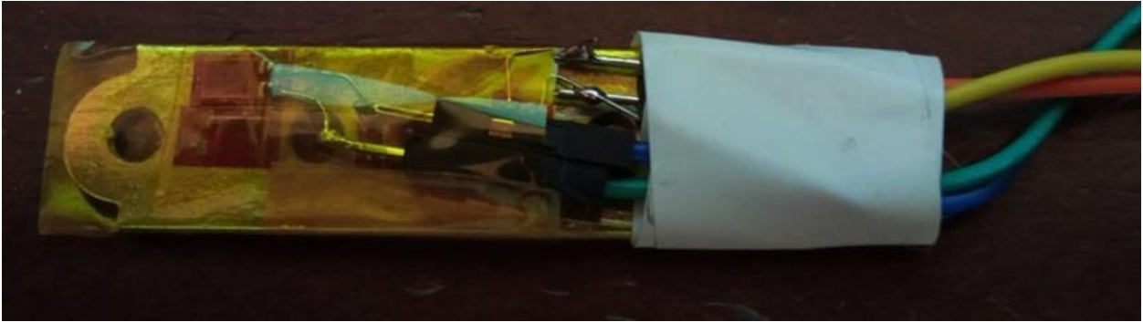
Εικόνα 7.20 Δοκίμιο χάλυβα με δύο strain gauges σε κάθετες διευθύνσεις.
