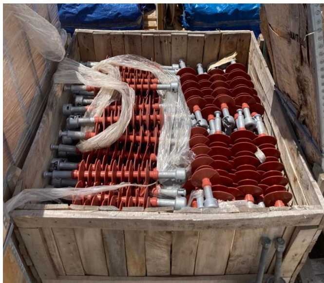
Εικόνα 4.1 Αποθήκευση συνθετικών μονωτήρων σε εξωτερικό χώρο στην ΠΑΧ ΔΕΔΔΗΕ
