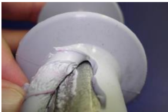
Εικόνα 2.2. Έλλειψη σύνδεσης στα ακροκιβώτια συνθετικού μονωτήρα [25]
