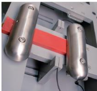
Εικόνα 2.9 Προετοιμασία δυναμικού τεστ πτώσης [25]
