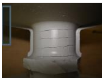
Εικόνα 2.3. Κοπή τετραγώνων στο συνθετικό περίβλημα [25]
