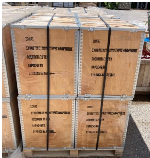
Εικόνα 4.2 Συσκευασία αποθήκευσης συνθετικών μονωτήρων σε εξωτερικό χώρο στην ΠΑΧ ΔΕΔΔΗΕ
