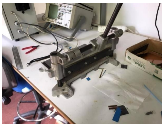
Εικόνα 13 Μηχάνημα κοπής φωτοευαίσθητής πλακέτας
