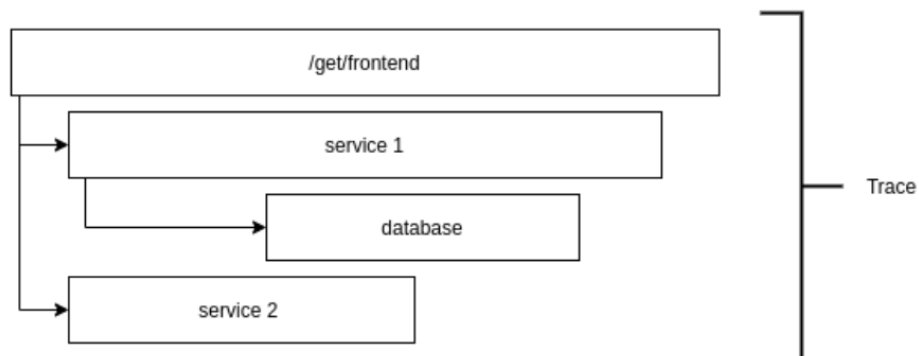
Εικόνα 6: Δομή trace με τα επιμέρους spans
